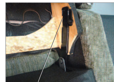
Soportes del respaldo y de la estructura acoplados
