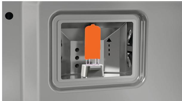
2. Retirez l'ampoule défectueuse de la douille.
