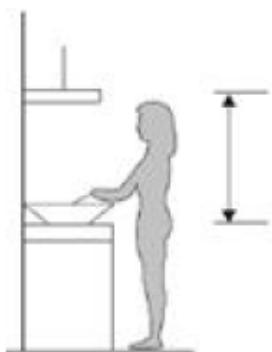
REMARQUE : La hotte doit être placée à une hauteur de 65 à 76 cm (25,6"-30") au-dessus de la surface de cuisson.
