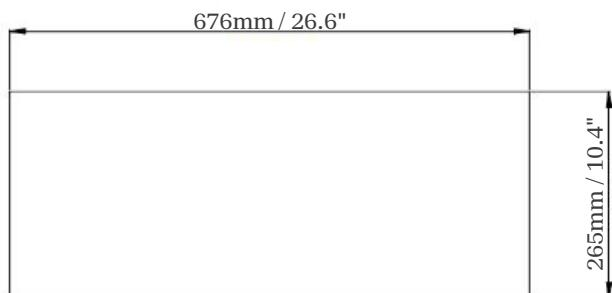
REMARQUE : Percez un trou de 676 à 265 mm (26,6" x 10,4") de large. Veillez à ce que la distance entre le bord du trou et le rebord de l'armoire avant et arrière soit d'au moins 35 mm (1,4") afin de centrer la hotte dans le cabinet. L'épaisseur du cabinet devrait être limitée à 15-25 mm/0,6- 0,98" pour le meilleur effet.
