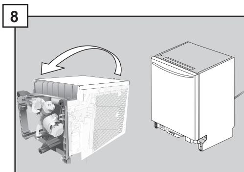
Faire basculer le lave-vaisselle vers l'avant pour qu'il soit à nouveau debout en s'assurant, d'une part, que le tuyau d'alimentation d'eau ne soit pas écrasé et, d'autre part.
