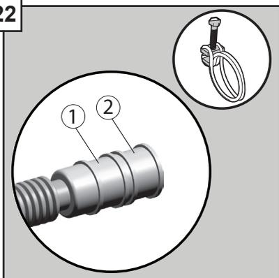
Conecte el desagüero manga a la plomería con abrazadera de tornillo (posicione 1 para 1/2" o posición 2 para 3/4") y apriete. No corte manga de desagüero.
