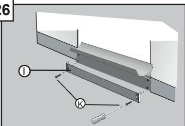
Fixez les vis (pièce K) à travers le panneau de plancher métallique (pièce I) aux trous inférieurs du panneau de plancher en plastique de façon à ce qu'il soit au niveau avec le plancher. Félicitations! L'installation est maintenant terminée.
