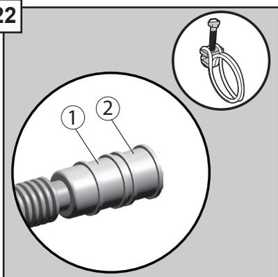
Attacher le tuyau d'égout la plomberie avec le serre-joint de vis (dispose 1 pour 1/2" ou dispose 2 pour 3/4") et resserre. Ne pas couper le tuyau d'égout.
