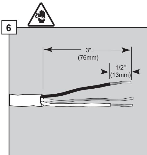
Dénuder le câble électrique de 3 po (76 mm) afin de faire apparaître les fils électriques intérieurs. Dénuder ensuite chacun de ces fils de 1/2 po (13 mm).\*
