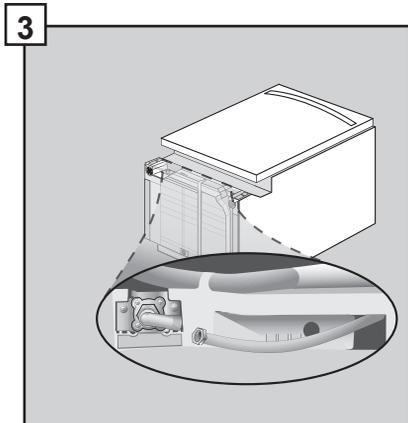
3 Fixer le raccord coude 90° au lave-vaisselle en l'orientant comme indiqué sur le schéma. Ne pas trop serrer.
