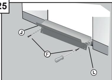
Glissez la vis (pièce F), du côté droit en premier, à travers le trou supérieur du panneau de plancher en plastique (pièce J), placez la rondelle (pièce L) à l'extrémité de la vis et fixez le panneau de plancher au lave-vaisselle en serrant la vis. Répétez ces étapes pour le côté gauche.
