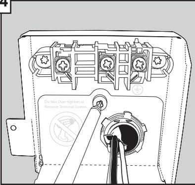
Coloque la placa montada del sujetacables nuevamente dentro de la caja de conexiones y vuelva a fijar el tornillo. Cerciérese de que la lengüeta en el lado derecho de la placa del sujetacables esté fuera de la caja de conexiones mientras la desliza hacia dentro.
