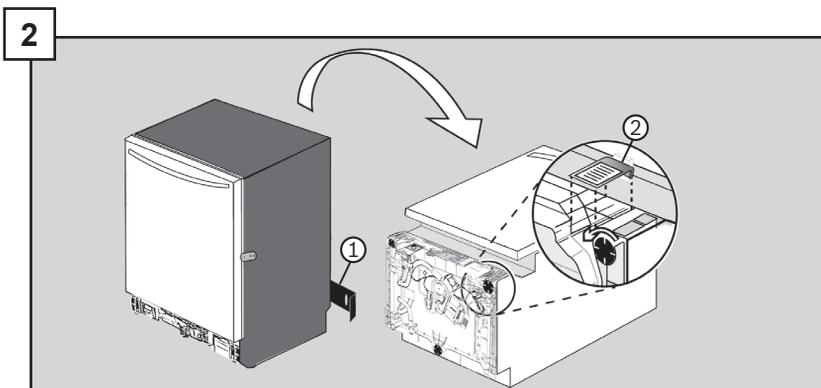
Coloque el lavaplatos suavemente sobre la parte trasera. Remueva el panel de la base. Afloje ligeramente los niveladores de la pata (2). Remueva la cubierta de la caja de conexiones y guárdela para uso posterior.
