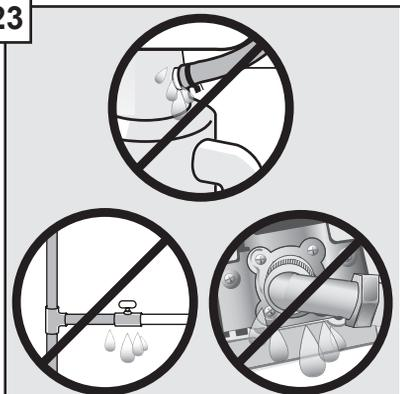
Relier le tuyau d'alimentation en eau à la valve d'arrivée d'eau chaude. Faire couler l'eau et vérifier qu'il n'y ait pas de fuite. Rétablir le courant électrique. Démarrer le lavage, écouter l'eau affluée et la pompe de distribution de l'eau. Presser arrêter la vidange/ Reponga et vérifier qu'il n'y ait pas de fuite.
