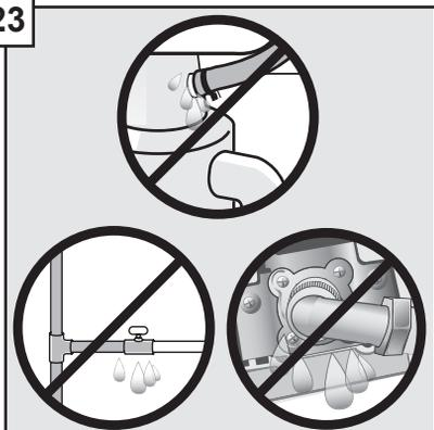
Una la línea del agua a la válvula de apagado del agua caliente. Prenda el agua y revise si hay fugas. Encienda la energía eléctrica en la caja de fusibles. Encienda el lavaplatos, escuche el agua y la bomba de distribución de agua. Presa cancele/Remette à l'état initial, a drene y revise si hay fugas.
