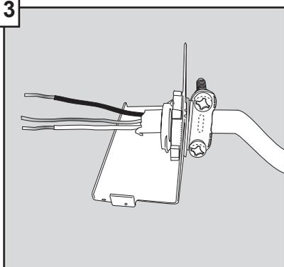
Faire passer le câble électrique à travers le réducteur de tension et la plaque. Serrer le serre-joint comme indiqué sur le schéma. À l'aide d'une pince, plier l'extrémité du câble électrique comme indiqué sur le schéma. Ceci facilitera l'installation de la plaque du réducteur de tension.
