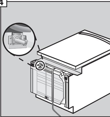
Una la línea del agua caliente al codo de 90° y dirijas debajo de la máquina hacia la unión de agua caliente. Asegúrese que la manguera no tenga contacto con las partes sueltas debajo de la unidad.
