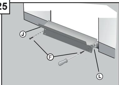
Primero, deslice el tornillo (pieza F) hacia el lado derecho a través del orificio superior del panel de pie de plástico (pieza J), coloque la arandela (pieza L) en el extremo del tornillo y acople el panel de pie al lavavajillas ajustando el tornillo. Repita el procedimiento para el lado izquierdo.
