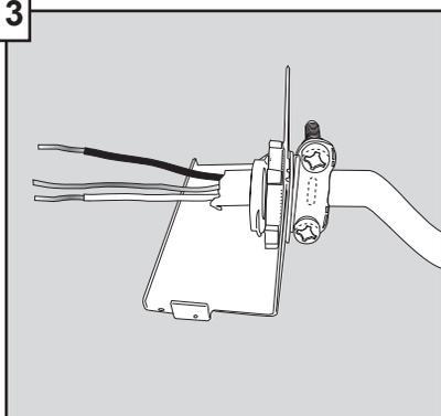
Pase los cables a través del sujetacables y la placa. Apriete la abrazadera alrededor de los cables, orientada como se demuestra. Doble el extremo del cable eléctrico como se demuestra. Esto ayudará a la instalación de la placa del sujetacables más adelante.
