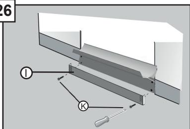
Coloque los tornillos (pieza K) a través del panel de pie de metal (pieza I) en los orificios inferiores del panel de pie de plástico de modo que quede a ras del piso. ¡Éxito! Su instalación está terminada.
