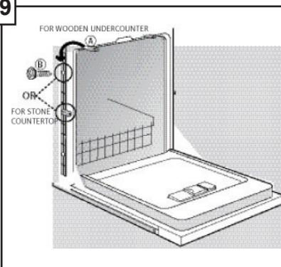
Si la encimera es de piedra, extraiga los soportes de montaje (A) de la parte superior y la posición de ellos en cualquiera de los puntos en el lateral. Inserte el tornillo (B) a través de pre-soportes colocados a cada lado de la unidad y fije los soportes.
