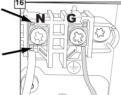
S'assurer que la partie dénudée (non isolée) de chaque fil soit bien visible au-dessous et au-dessus de chaque vis principale. Visser avec soin ces dernières **sans serrer trop fort** car cela pourrait entraîner des dégâts matériels.
