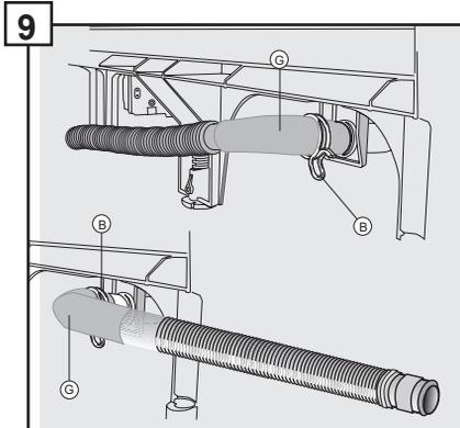
Orienter le tuyau vers la direction d'évier. **IMPORTANT** : Le tuyau de route vers l'évier AVANT la connexion. Ne pas tourner après attachement. Connectez le tuyau de vidange (G) au dos de lave-vaisselle en utilisant des pinces pour serrer la pince (B).
