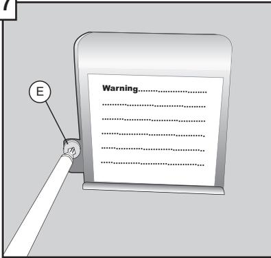
Remplacer le couvercle de la boîte de jonction. S'assurer qu'il soit bien placé derrière la face avant de la plaque du réducteur de tension. Fixer la plaque grâce à la vis (pièce E du kit d'installation).
