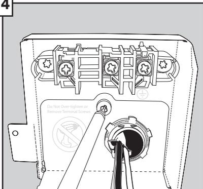
Replacer alors la plaque du réducteur de tension dans la boîte de jonction et replacer la vis. S'assurer que l'étiquette située en bas de la plaque se trouve à l'extérieur de la boîte de jonction au moment de l'assemblage.
