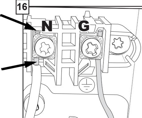
Cerciérese de que la porción expuesta (no-aislada) de cada alambre pelado aparezca sobre y debajo del tornillo terminal. Apriete con seguridad los tornillos terminales, pero no **los sobre apriete** pues esto puede ocasionar daños.
