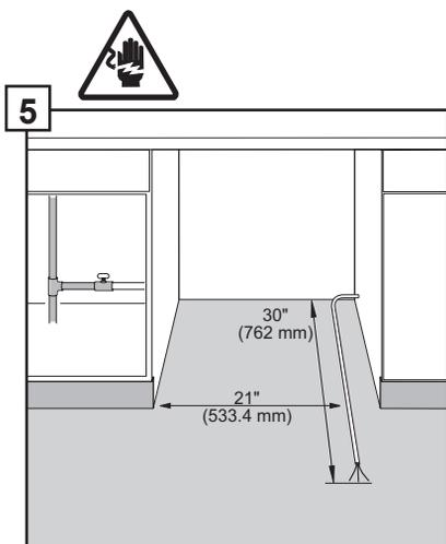
5 Couper le courant électrique qui doit alimenter le lave-vaisselle. Indépendamment d'où vient le câble électrique, il faut le placer à 21 po (533.4 mm) de distance du côté gauche de l'emplacement réservé au lave-vaisselle et le faire courir sur 30 po (762 mm) depuis le mur du fond.
