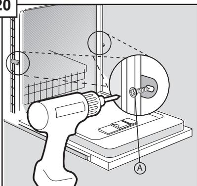
Inserte los tornillos (parte A) a través de los soportes de montaje previamente colocados y coloque la unidad en el recinto (se recomienda taladrar los agujeros previamente). Saque la rejilla superior antes de insertar los tornillos.
