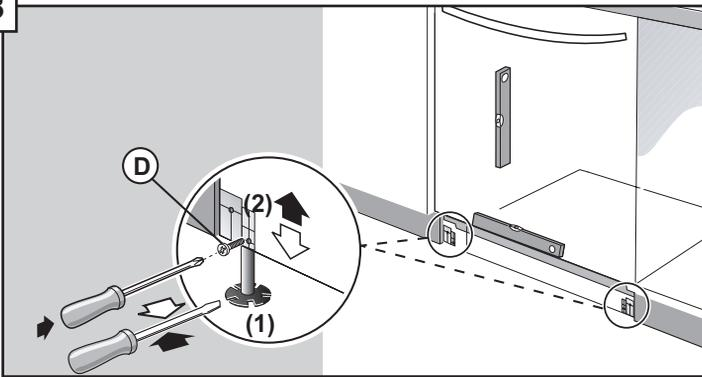
Nivele el lavaplatos horizontalmente girando los pies (1) en sentido de las manecillas del reloj (derecha) para levantar o en sentido opuesto (izquierda) para bajar la parte frontal de la unidad. Una vez nivelado, (2) inserte los tornillos de la pata niveladora (parte D) y apriete.
