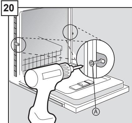
Placer les vis (pièces A du kit d'installation) dans les fixations et visser afin que le lave-vaisselle soit solidement fixé au plan de travail (il est recommandé de percer préalablement les trous dans le plan de travail). Enlever la grille supérieure avant d'insérer les vis.
