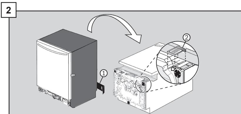
Coucher le lave-vaisselle sur sa partie arrière. Retirer le panneau inférieur. Desserrer les niveleurs des pieds (2). Enlever le couvercle de la boîte de jonction et le mettre de côté pour pouvoir le replacer plus tard.
