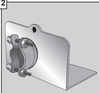
Una el sujetacables (no incluido) a la placa del sujetacables. Los dos tornillos en la parte trasera del sujetacables se deben colocar según lo demostrado para prevenir interferencias durante el montaje. Apriete la tuerca de fijación del sujetacables para evitar que éste gire.
