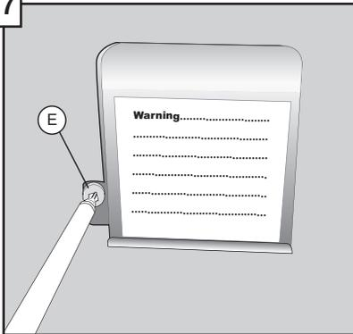
Coloque la cubierta de la caja de conexiones. Cerciórese de que la cubierta esté asentada detrás del borde delantero de la placa del sujetacables. Una la cubierta con el tornillo (parte E) del equipo de instalación.
