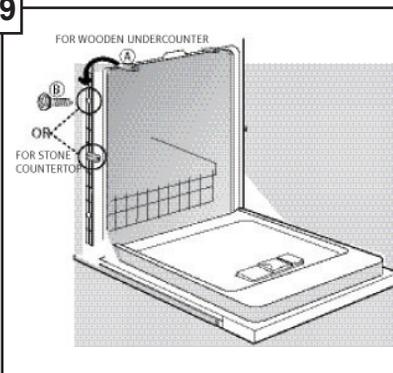
Si votre comptoir est en pierre, détacher les supports de montage (A) par le haut et leur position à chaque points sur le côté. Introduire la vis (B) par le biais de pré-supports situés de chaque côté de l'unité et fixez les supports.
