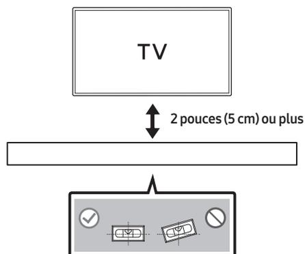
2. Alignez la **Ligne Centrale** du **Guide de montage mural** sur le centre de votre téléviseur (si vous montez le Soundbar sous ce dernier), puis fixez le **Guide de montage mural** au mur avec du ruban adhésif.
