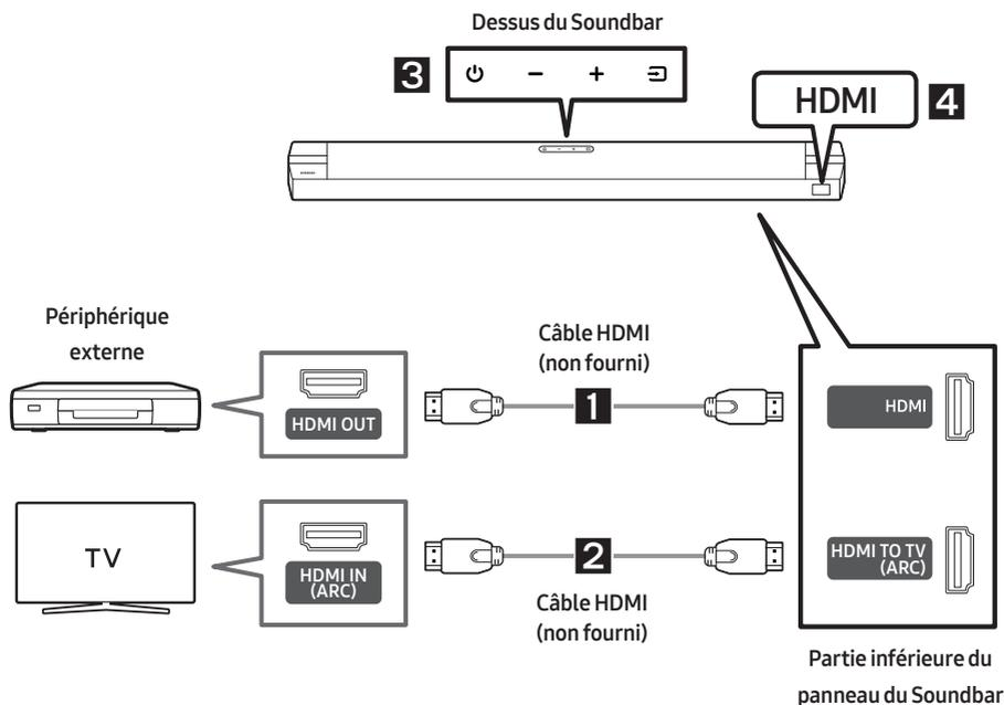
1. Branchez un câble HDMI (non fourni) entre le port **HDMI** au bas du Soundbar et le port HDMI OUT de votre appareil numérique.
