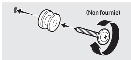
6. Installez les 2 **Support de fixation murale** selon l'orientation correcte en bas de la Soundbar, à l'aide de 2 **Vis**.
