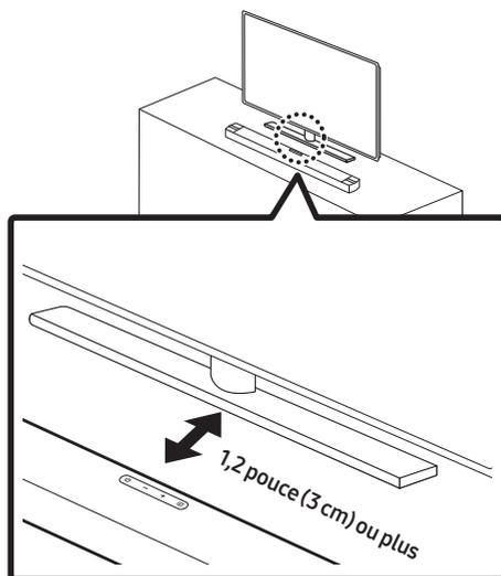
Comme illustré sur l'image, alignez le centre du Soundbar avec le centre du téléviseur, puis placez soigneusement le Soundbar sur le support du téléviseur.
