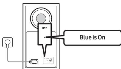
Le voyant LINK cesse de clignoter et s'allume en bleu fixe lorsqu'une connexion est établie entre le Soundbar et le caisson de basses sans fil.
