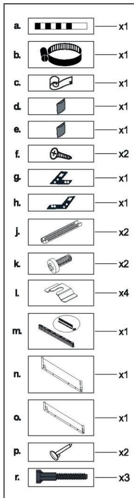
Les pièces nécessaires au positionnement du lave-vaisselle sont dans des sacs en plastique. Vérifiez que toutes les pièces suivantes se trouvent dans les sacs en plastique.
