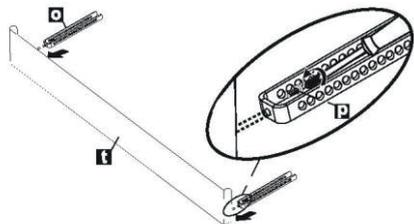
1. A. Si la hauteur est comprise entre 33 7/8" et 35 7/8" (860 - 910 mm) et que vous utilisez des pattes courtes, une plinthe réglable en métal d'une hauteur de 80 mm (v), des pattes de plaque de protection (o) sont installés. Le montage se fait à l'aide de vis de Ø 5/32 "x 7/32" (Ø 4 mm x 6 mm) à l'aide d'un tournevis cruciforme.
