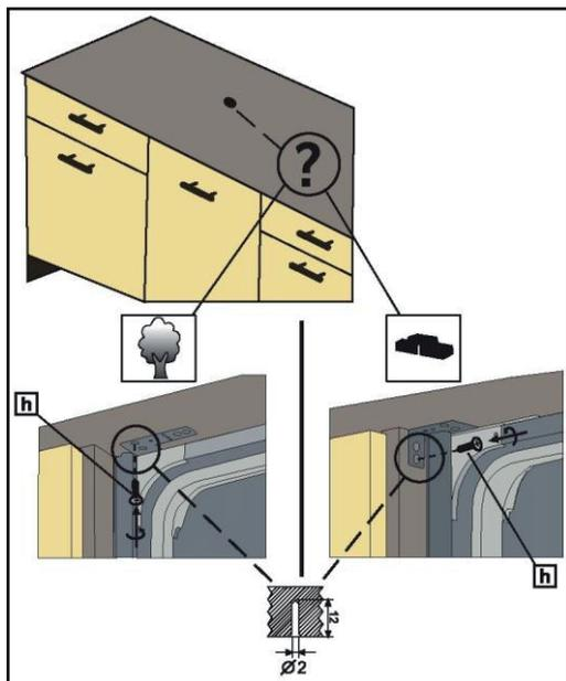
10- Les pattes de montage précédemment fixées au lave-vaisselle sont également fixées au meuble à l'aide de vis de Ø 5/32 "x 19/32" (Ø 4 mm x 15 mm).
