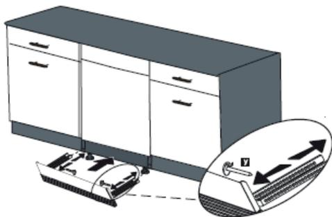
3. En fonction de la profondeur désirée, le système de blocage de la plinthe (y) est fixé à la patte de la plaque de protection (o).
