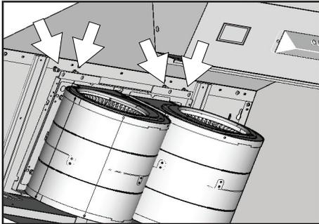
5. Positionner le ventilateur double à l'intérieur du corps de la hotte comme illustré. Assurez-vous de bien insérer la plaque du ventilateur double dans les languettes de la plaque du ventilateur. Fixez le ventilateur double à l'aide des (4) vis précédemment retirées à l'étape 2.
