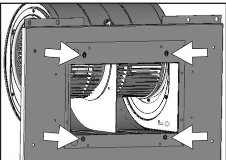
3. Retirez les (4) vis fixant le ventilateur simple à la plaque du ventilateur simple.
