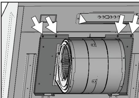
2. Retirez les (4) vis de l'intérieur du corps de la hotte fixant la plaque du ventilateur unique au haut du corps de la hotte. Retirez le ventilateur simple et la plaque de ventilateur simple.
