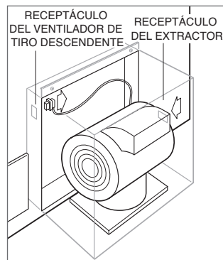
Conexión del extractor.
