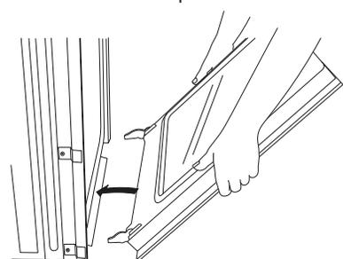
Saisir les bords de la porte du four avec les deux mains. Insérer les charnières en même temps et pousser la porte du four dans les fentes de la cavité du four pour la réinstaller. Si nécessaire, basculer doucement la porte d'un côté et de l'autre en la poussant.
