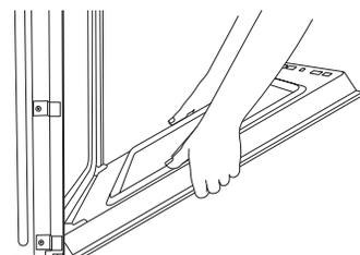
Commencer à fermer doucement la porte. La porte s'arrêtera en position partiellement fermée.
