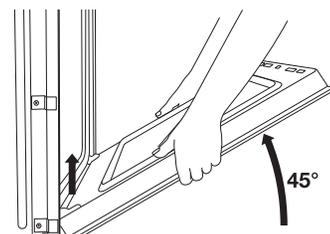
Saisir les bords de la porte du four avec les deux mains. Fermer la porte du four légèrement dépassé la position d'arrêt pour réduire la charge supportée par les loquets, puis tirer la porte de four vers le haut.
