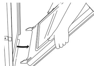
Tirer la porte du four vers soi et enlever la porte. Si nécessaire, basculer doucement la porte d'un côté et de l'autre en la tirant.
