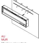
Montage nécessitant au moins trois (3) montants de cloison
