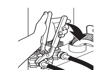
Ne pas serrer excessivement ni utiliser de ruban adhésif ou de dispositif d'étanchéité lors de la fixation aux robinets.
