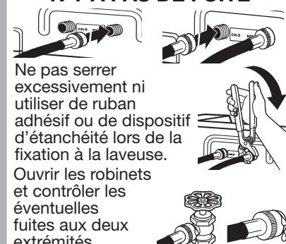
Ne pas serrer excessivement ni utiliser de ruban adhésif ou de dispositif d'étanchéité lors de la fixation à la laveuse.
