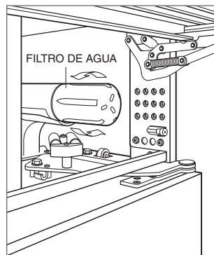
Extracción del filtro de agua.
