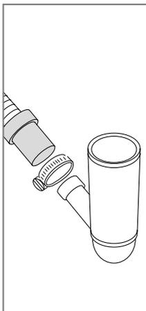
Le tuyau d'évacuation peut aussi être raccordé à un embout sur le siphon de l'évier. L'embout doit avoir un diamètre interne d'au moins 0.6" (14 mm).
