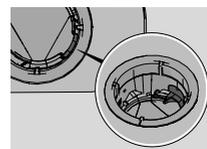
Vérifiez que la butée colorée à droite dans le drain inférieur est en place.
