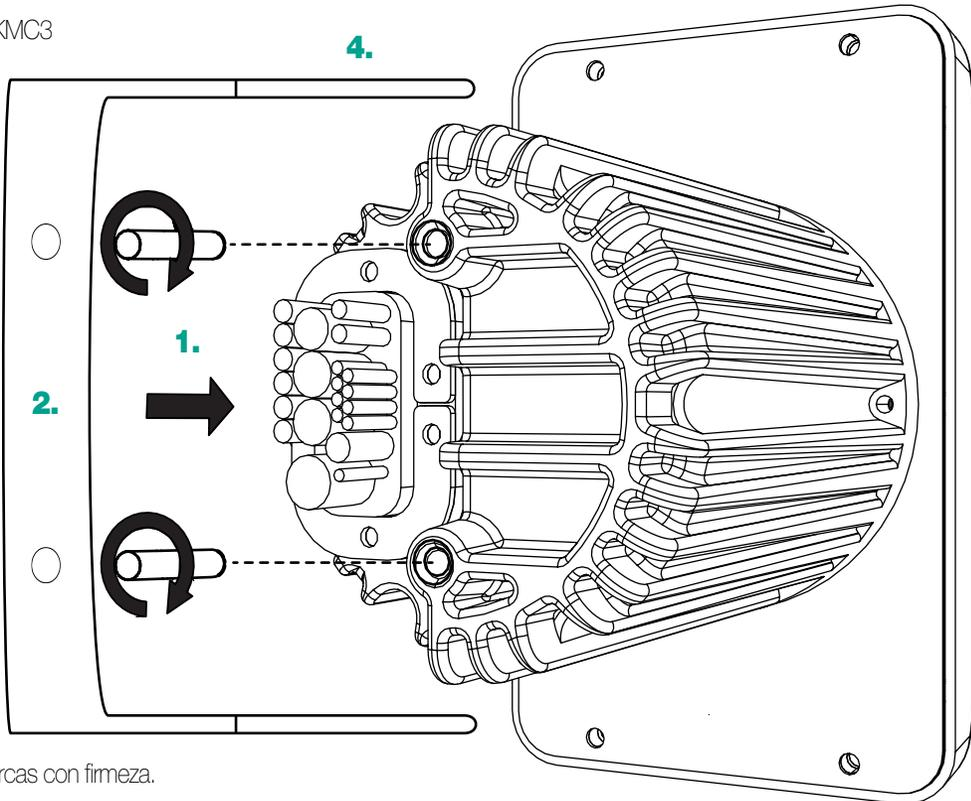
**3.** Coloque las arandelas sobre los tornillos y ajuste las tuercas con firmeza.
