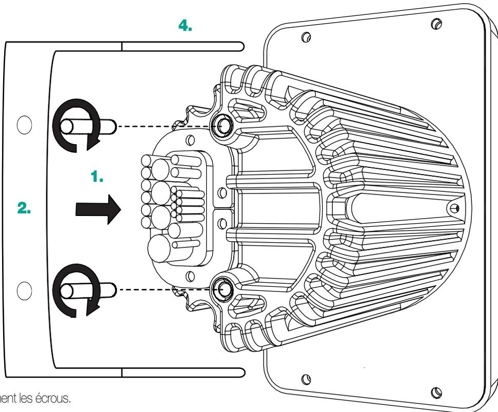
3. Placez les rondelles sur les boulons, puis vissez fermement les écrous.
