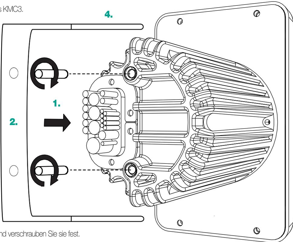
**3.** Bringen Sie die Unterlegscheiben über den Bolzen an und verschrauben Sie sie fest.
