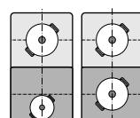
Les foyers avant et arrière peuvent être utilisés indépendamment avec chacun deux inducteurs. Le niveau de puissance est réglé individuellement pour chaque foyer. Utilisez seulement un ustensile de cuisson sur chaque foyer.
