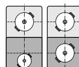
Las zonas de cocción delantera y trasera, con dos inductores cada una, se pueden utilizar de forma independiente. La posición de cocción se ajusta individualmente para cada zona de cocción. Utilizar un solo recipiente para cada zona de cocción.
