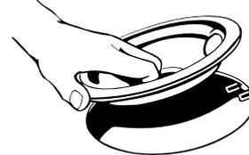
2. Tenir l'élément en spirale le plus possible de niveau et pousser doucement la fiche de l'élément en spirale dans la prise.
