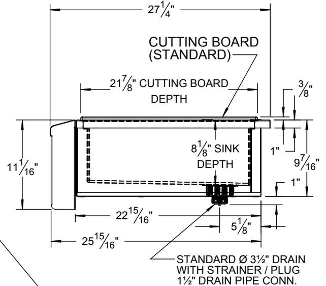
STANDARD  $\varnothing$  3 1/2" DRAIN WITH STRAINER / PLUG
