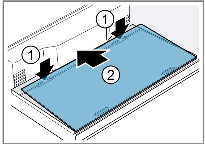
2. Asir ① las dos hendiduras de la parte delantera de la base del compartimiento frigorífico y levantar la placa de vidrio para extraerla ②.
