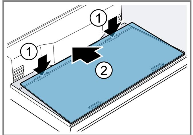
2. Saisissez les deux évidements à l'avant du fond du compartiment réfrigération ①, soulevez la plaque en verre du compartiment réfrigération et retirez-la ②.
