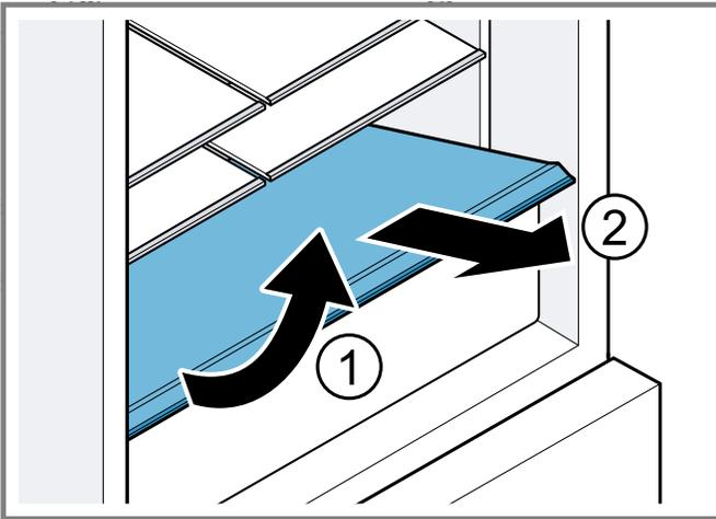
2. Levantar el cajón fresco por delante ① y retirar ②.
