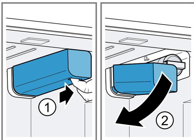
2. Girar el filtro del agua 90° en sentido opuesto a las agujas del reloj ① y retirarlo ②.
