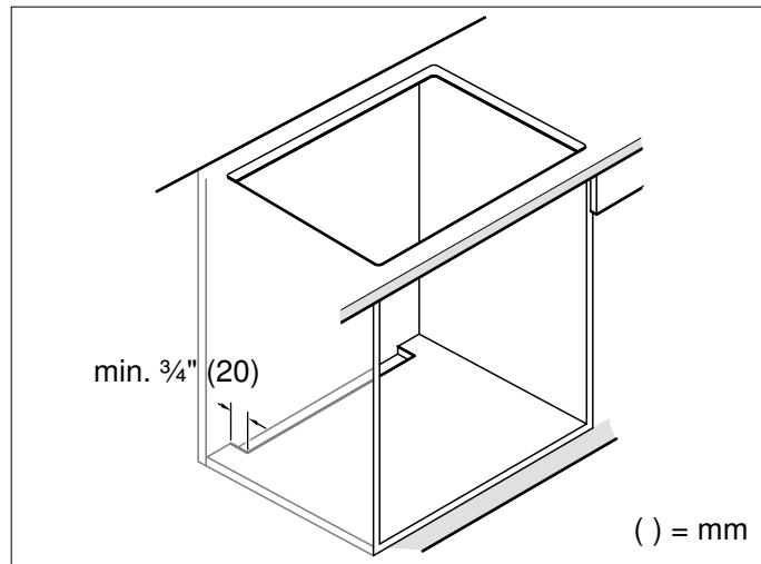
**Nota:** Si el aparato se instala en una unidad de isla u otra instalación que no se describe aquí, se deberá comprobar que la placa de cocción esté suficientemente ventilada.
