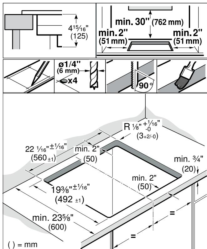
**Combinación de distintos aparatos Vario:** Tener en cuenta la necesidad de contar con espacio adicional para la junta de unión VV 200 a la hora de crear el hueco. Los aparatos también se pueden instalar en huecos individuales si se mantiene un espacio mínimo de 1 1/2" (40 mm) entre ellos.
