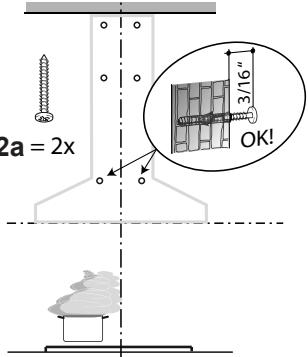
Insérez partiellement les deux vis 12a fournies dans les trous de fixation du bâti de la hotte, comme illustré.
