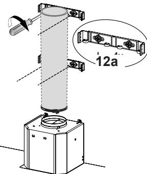
Installez les 2 brides de fixation 7.2.1 à l'aide des trous percés au milieu et au haut, et fixez-les à l'aide de vis 12a, comme illustré.
