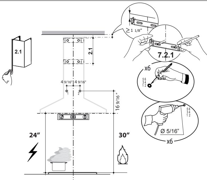
Dibuje una línea horizontal donde se indica en el borde inferior de la campana de ventilación a la altura deseada sobre la superficie de cocción.
