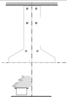
Los tornillos de instalación suministrados deben asegurarse con tacos de pared (se adquieren por separado).
