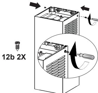
Asegure los lados a los soportes con los 2 tornillos 12b.
