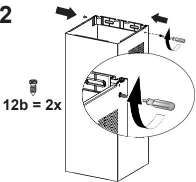
Asegure los lados a los soportes con los 2 tornillos 12b.
