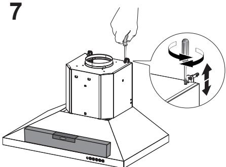
Use un nivel para asegurar que el cuerpo de la campana esté nivelado y luego asegure completamente los dos tornillos.
