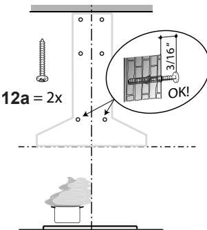
Inserte no completamente los dos tornillos 12a suministrados en los orificios de fijación del cuerpo de la campana, como se muestra.
