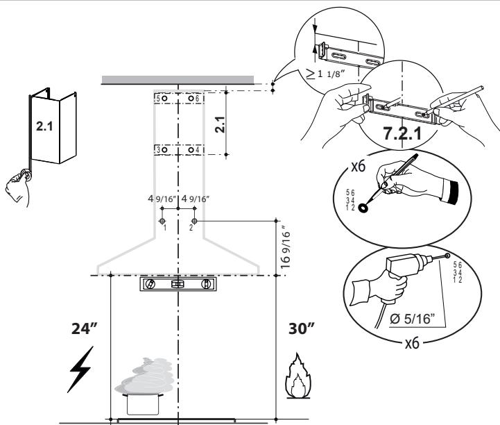
Tracez une ligne horizontale à l'endroit indiqué au bas de la hotte à évacuation, à la hauteur souhaitée par rapport à la surface de cuisson.
