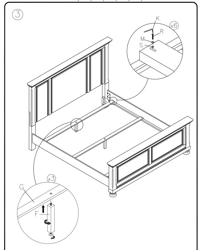
Turn Adjustable Leveler on the bottom of the Cross Slat Center Leg F until it contacts the floor. Gire el nivelador ajustable de la parte inferior de la pata central transversal F hasta que haga contacto con el piso.
