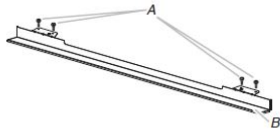
A. Tornillos de cabeza Phillips (4), solo 2 tornillos para el tamaño de 27" (68,6 cm) B. Deflector para cajón de calentamiento (1)
