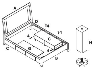
TURN LEVELER UNDERNEATH STORAGE FEETS (**H**) TO ADJUST THE STORAGES (**G**) LEVEL AS SHOWN ON ILLUSTRATION.
