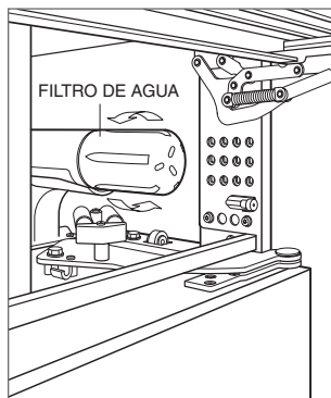
Extracción del filtro de agua
