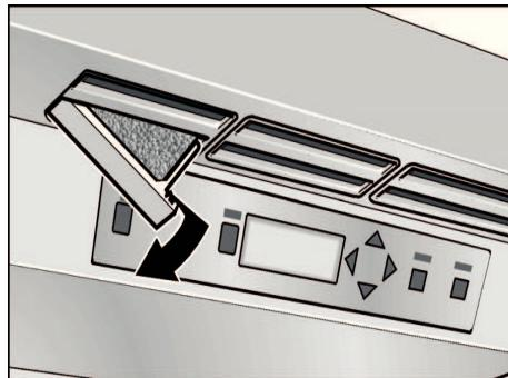
2. Extrayez le filtre épuisé et mettez un filtre neuf en place.
