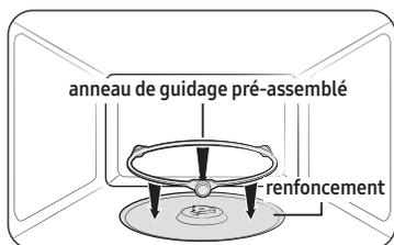
3. Installez l'anneau pré-assemblé dans le renforcement au centre du four à micro-ondes.
