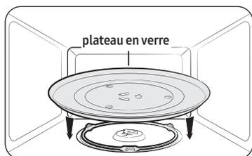
4. Placez le plateau en verre solidement au centre de l'anneau de guidage pré-assemblé.
