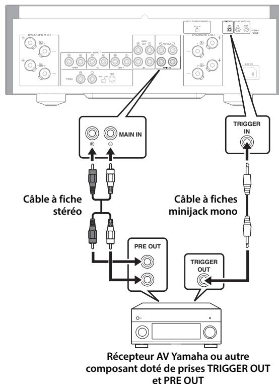
Quand le composant connecté est mis sous tension, cet appareil est automatiquement mis sous tension. La source d'entrée de cet appareil est simultanément réglée sur MAIN DIRECT.
