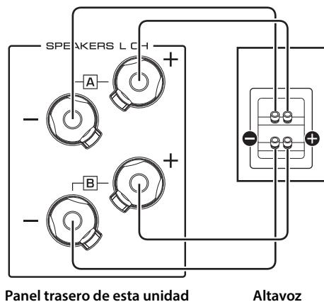
**3 Establezca el selector SPEAKERS del panel delantero en A+B BI-WIRING.**
