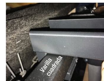
Soporte "enganchado" en la varilla cuadrada
