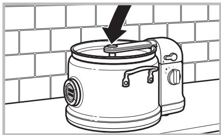
3. Alinee la parte posterior de la olla multifunción con la parte frontal del brazo mezclador. Baje la olla multifunción hasta el puerto de alimentación de conexión fácil en la base del brazo mezclador.
