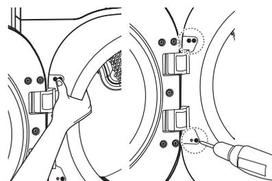
9 Insérez le verrou du côté droit et installez les vis du verrou.
