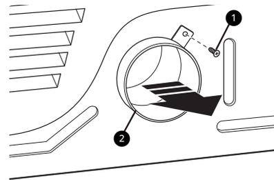
**2** Appuyez sur les languettes de la rondelle défonçable **3** et retirez-la soigneusement pour obtenir l'ouverture de ventilation souhaitée. (La ventilation par le côté droit n'est pas offerte sur les modèles au gaz.) Appuyez sur le conduit de l'adaptateur **4** pour l'insérer dans le boîtier du ventilateur et fixez-le à la base de la sècheuse, comme il est illustré.
