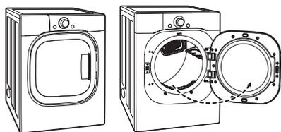
2 Retirez les vis indiquées ci-dessous (six à gauche, quatre à droite).
