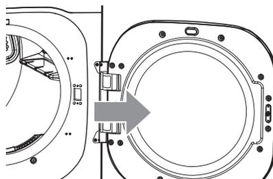
7 Déplacez la porte vers la gauche et alignez les trous de la charnière avec les trous de l'armoire.
