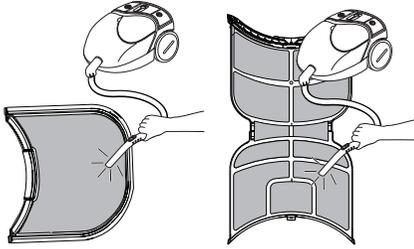
**3** Si le filtre est très sale ou bouché par un produit assouplissant, lavez le filtre à fibres dans une solution d'eau chaude savonneuse, puis laissez-le sécher complètement avant de le réinstaller.
