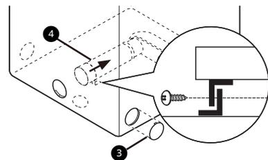
**3** Assemblez un coude **5** de 4 po (10,2 cm) à la section de conduit de 4 po (10,2 cm) suivante et recouvrez tous les joints de ruban à conduit. Assurez-vous que l'extrémité mâle du coude est orientée VERS L'EXTÉRIEUR de la sècheuse. Insérez l'ensemble coude-conduit dans l'ouverture latérale et raccordez-le au conduit adaptateur. Recouvrez le joint de ruban à conduit. Faites en sorte que l'extrémité mâle du conduit dépasse de 1,5 po (3,8 cm) à l'extérieur pour le raccordement au
