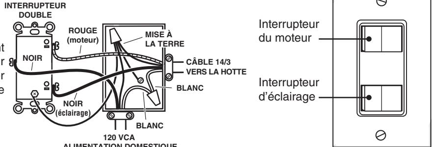
**NOTE:** Prévoir une longueur adéquate de câble 14/3 pour réaliser la connexion du fil ROUGE à l'avant de la hotte.
