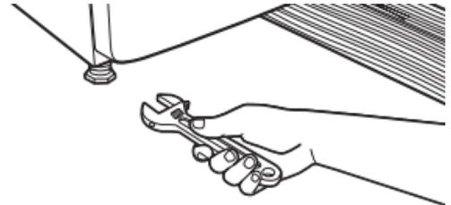
Si la sécheuse n'est pas d'aplomb, la relever à l'aide d'un bloc de bois. Utiliser une clé pour ajuster les pieds vers le haut ou vers le bas, et vérifier à nouveau si elle est d'aplomb.
