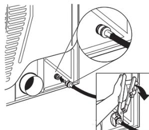
Au besoin, ôter le capuchon protecteur de l'orifice d'arrivée d'eau. Fixer l'autre extrémité du long tuyau à l'électrovanne au panneau arrière de la sécheuse. Visser le raccord à la main jusqu'à ce qu'il repose sur le connecteur de l'électrovanne. Terminer le serrage des raccords de deux tiers de tour supplémentaire avec une pince.
