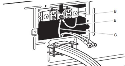
Connecter le conducteur neutre (E) et le conducteur neutre (blanc ou central) (C) du câble d'alimentation ou du câble sous la vis de la borne centrale (B). Serrer la vis.
