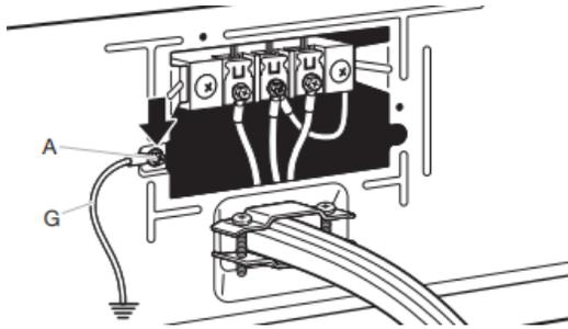
Raccorder un autre conducteur de terre en cuivre (G) depuis la vis du conducteur de terre externe vert (A) jusqu'à une terre adéquate. Placer la languette du couvercle du bornier dans la fente du panneau arrière de la sécheuse. Fixer le couvercle avec la vie de retenue. Ensuite, aller à la section « Exigences concernant l'évacuation ».
