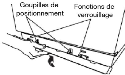
Installation : Placer la jupe au bas de la sècheuse et faire correspondre les goupilles de positionnement avec les trous. Appuyer sur la jupe fermement vers le haut jusqu'à ce qu'elle s'enclenche.
