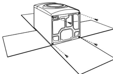
Afin d'éviter d'endommager le plancher, utiliser un grand morceau de carton plat extrait de la boîte d'emballage de la sècheuse et le placer sous toute la partie arrière de la sècheuse. Saisir fermement le corps de la sècheuse (et non pas le panneau de la console), puis poser la sècheuse sur le carton avec précaution.
