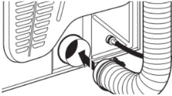
À l'aide d'une bride de fixation de 4 po (102 mm), relier le conduit d'évacuation à la bouche d'évacuation de la sécheuse. Si l'on réalise le raccordement au conduit d'évacuation existant, s'assurer que celui-ci est propre. Le conduit d'évacuation doit être fixé par-dessus la bouche d'évacuation de la sécheuse et à l'intérieur du clapet d'évacuation. S'assurer que le conduit d'évacuation est fixé au clapet d'évacuation à l'aide d'une bride de fixation de 4 po (102 mm).
