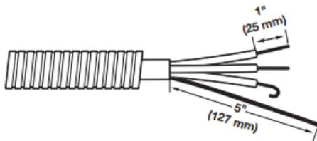
Le câble à raccordement direct doit avoir une longueur supplémentaire de 5 pi (1,52 m) pour pouvoir déplacer la sècheuse si nécessaire.
