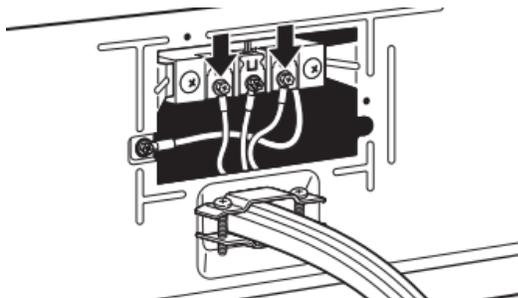
Connecter les conducteurs restants sous les vis les plus à l'extérieur du bornier. Serrer les vis. Placer la languette du couvercle du bornier dans la fente du panneau arrière de la sècheuse. Fixer le couvercle avec la vis de retenue. Ensuite, aller à la section « Exigences concernant l'évacuation ».
