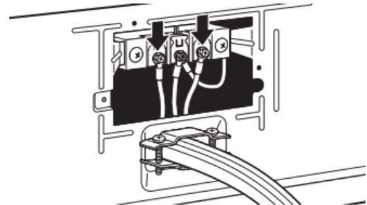
Placer les conducteurs restants sous les vis les plus à l'extérieur du bornier. Serrer les vis.
