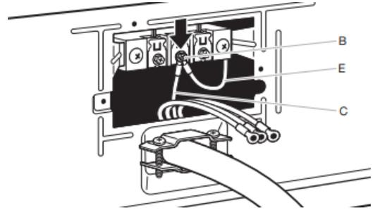
Connecter le conducteur neutre (E) et le conducteur neutre (blanc ou centre) (C) du câble d'alimentation sous la vis de la borne centrale (B). Serrer la vis.
