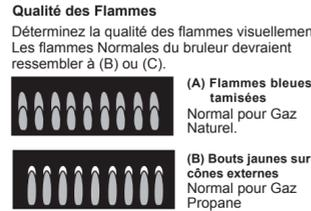
Des langues de flamme non brillantes ne sont pas normales. Les flammes normales peuvent avoir une teinte orange lorsqu'elles sont chauffées ou orange et vacillante à cause de particules dans le gaz ou l'air.
