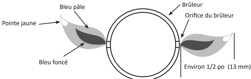
**Brûleur tubulaire :** Le brûleur est fait d'acier inoxydable 304, mais en raison de la chaleur extrême et d'un environnement corrosif, il se produira une corrosion de surface. Enlevez cette corrosion à l'aide d'une brosse en laiton. Nettoyez les orifices bouchés à l'aide d'un trombone déplié. N'agrandissez surtout pas les orifices du brûleur.
