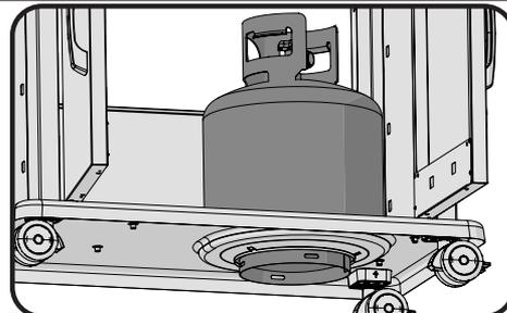
**Installation bouteille de propane :** Placez le cylindre dans le trou dans la tablette du bas. D'autres bouteilles peuvent être acceptables à condition qu'ils s'adaptent pas correctement dans l'anneau de bassin de rétention.
