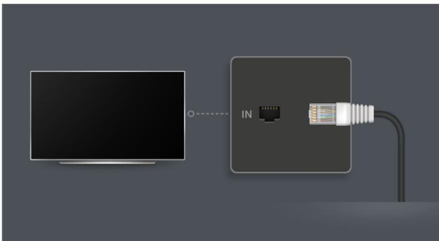
01 Branchez le routeur au port LAN du téléviseur à l'aide d'un câble LAN.
