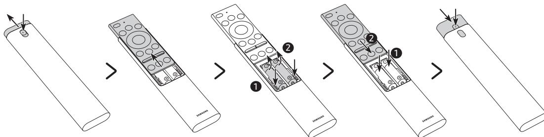
1. Appuyez sur la touche
