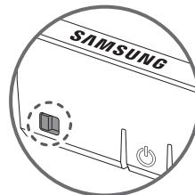
Vous pouvez activer et désactiver le capteur sonore au moyen du bouton qui se trouve dans le bas du téléviseur. Lorsque le téléviseur est allumé, il vous suffit de pousser le bouton vers la gauche pour activer le capteur sonore, et vers la droite pour le désactiver.
