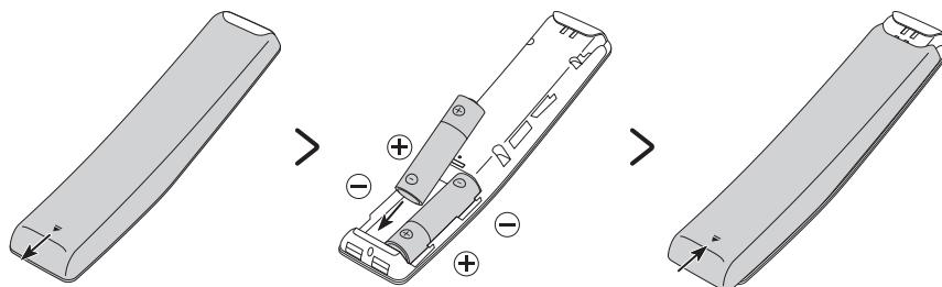
Pour installer les piles, ouvrez le couvercle à l'arrière dans le sens indiqué par la flèche au bas sur l'illustration, et insérez ensuite les piles (de type AA 1,5 V) conformément à l'illustration. Assurez-vous que les polarités positif et négatif donnent dans le bon sens. Fermez le couvercle à l'arrière conformément à l'illustration.
