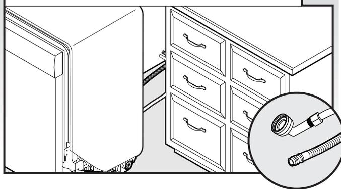
Vérifier que la canalisation d'eau se trouve sur le côté gauche de l'ouverture du placard, et que le tuyau d'évacuation se trouve près du centre de l'ouverture du placard.
