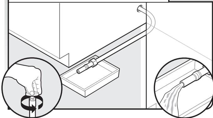
Tourner lentement le robinet d'arrêt jusqu'à la position "ON" (marche). Vider l'eau dans un plat peu profond pour éliminer les particules et débris qui pourraient obstruer l'électrovanne d'admission. Tourner le robinet d'arrêt jusqu'à la position "OFF" (arrêt).
