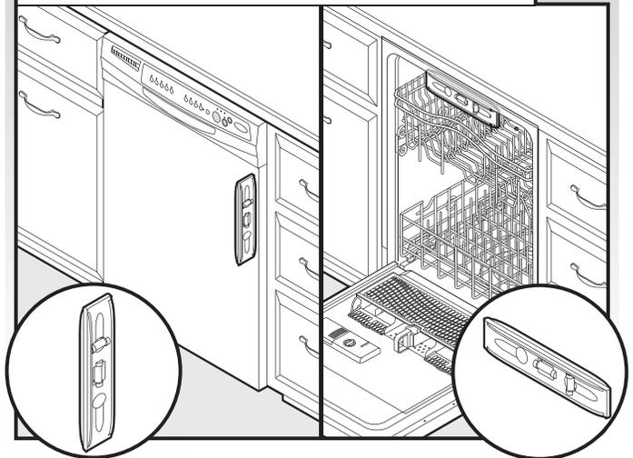
Vérifier que le lave-vaisselle est toujours d'aplomb d'avant en arrière et transversalement dans l'ouverture d'encastement du placard.
