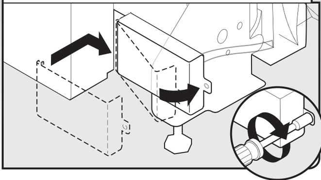
Placer les conducteurs à l'intérieur du boîtier de connexion. Insérer les languettes du côté gauche du couvercle. S'assurer que les fils sont bien logés à l'intérieur du boîtier. Fermer le couvercle tout en veillant à ne pas coincer de fils. Fixer le couvercle à l'aide d'un tourne-écrou de 1/4" et de la vis précédemment retirée.
