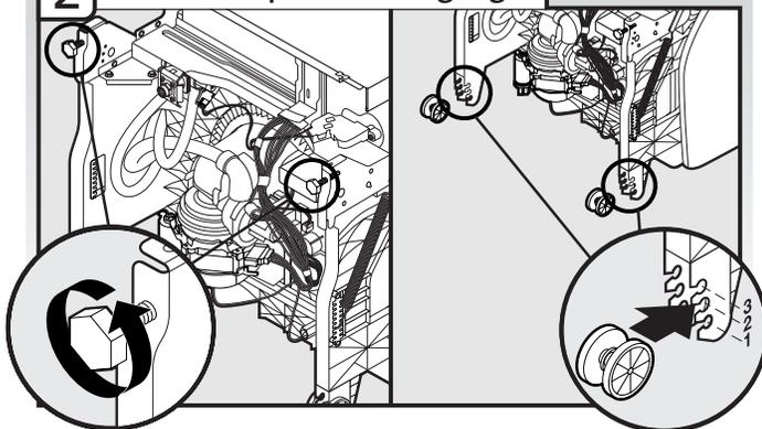
Ajuster (vissage) les deux pieds de réglage de l'aplomb à la même hauteur. Placer les roues à la position nécessaire selon les indications du "Tableau de réglage - Hauteur du lave-vaisselle".
