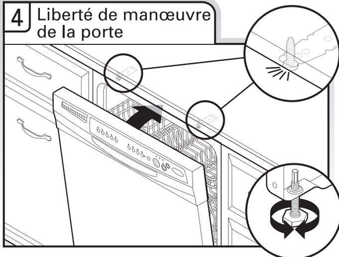
Vérifier qu'il n'y a aucun contact entre le sommet de la porte et les vis, les brides ou le plan de travail. Régler les pieds de nivellement le cas échéant.
