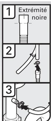
1. Raccorder l'extrémité noire du tuyau d'évacuation au dispositif de brise-siphon et couper si nécessaire.
