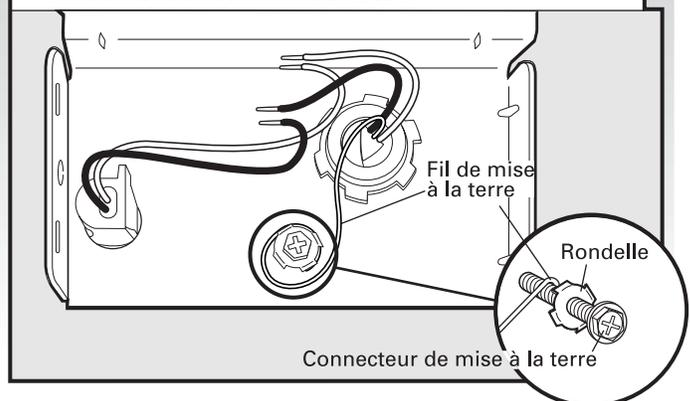
Former un crochet en U avec le conducteur nu de liaison à la terre. Enrouler le crochet du conducteur de liaison à la terre sur la vis de liaison à la terre et sous la rondelle (dans le sens horaire). Serrer fermement le connecteur de liaison à la terre.
