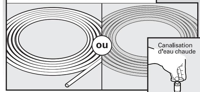
Mesurer la longueur totale de la canalisation de cuivre ou de la canalisation d'arrivée d'eau flexible à tresse d'acier. Fixer la canalisation d'eau chaude à l'aide d'une configuration de raccordement qui soit conforme à tous les codes et règlements locaux. La canalisation d'eau raccordée au lave-vaisselle doit comporter un robinet d'arrêt manuel.
