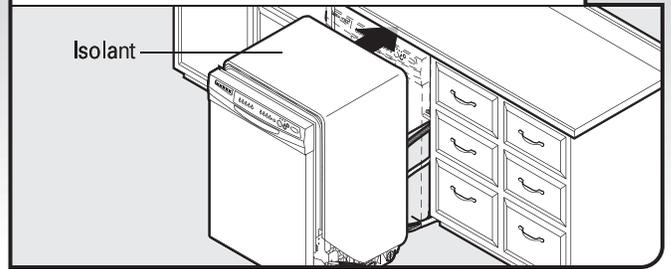
**IMPORTANT :** Si l'on enlève les roulettes, éviter d'endommager le plancher lors des déplacements du lave-vaisselle. Insérer lentement et complètement le lave-vaisselle dans l'ouverture d'encastrement du placard. Veiller à ne pas coincer ou déformer la canalisation de cuivre, le tuyau d'évacuation, le cordon d'alimentation ou le câble de raccordement direct entre le lave-vaisselle et le placard. Enlever le carton placé sous le lave-vaisselle.
