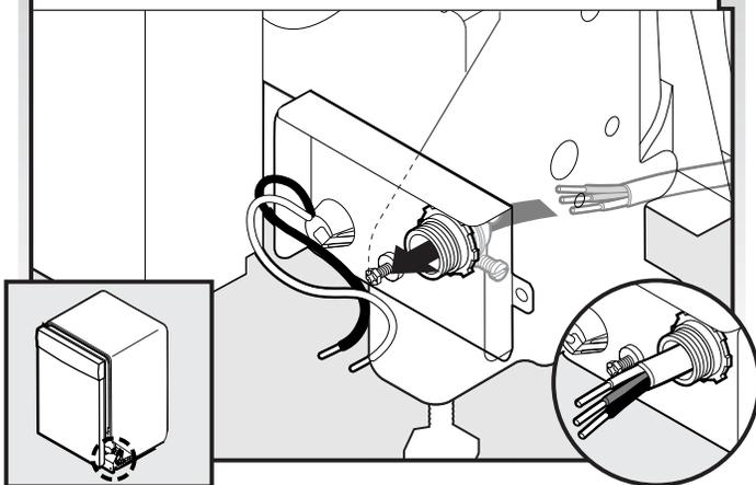
Acheminer le cordon d'alimentation de façon à ce qu'il ne touche ni le moteur du lave-vaisselle, ni la partie inférieure de la cuve du lave-vaisselle. Tirer le câble pour le faire passer à travers le serre-câble (homologation UL/CSA) dans le boîtier de connexion. Le serre-câble n'est pas fourni avec le lave-vaisselle. Le propriétaire doit acheter un serre-câble à vis de 7/8".
