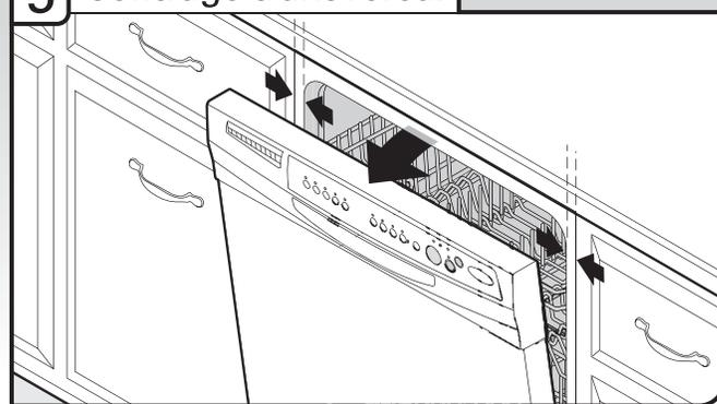
Ouvrir la porte et vérifier que la distance entre l'ouverture du placard pour l'installation du lave-vaisselle et la cuve est la même des deux côtés. Si la distance n'est pas la même, desserrer les vis des brides d'arrimage et déplacer légèrement la cuve. Resserrer les vis de brides.
