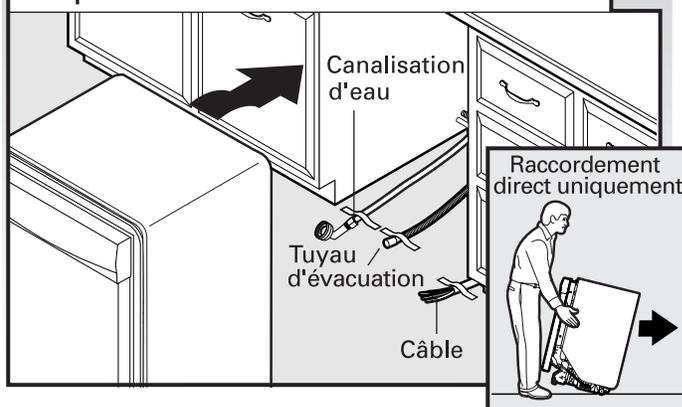
**IMPORTANT :** Vérifier que le câblage est installé au bon endroit. Saisir les côtés du lave-vaisselle par les rebords du panneau de porte. Incliner le lave-vaisselle vers l'arrière sur ses roulettes et approcher l'appareil de l'ouverture dans le placard.
