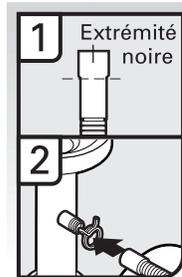
1. Raccorder l'extrémité noire du tuyau d'évacuation à la canalisation d'égout en T et couper si nécessaire. **REMARQUE :** Ne pas couper la section ondulée.
