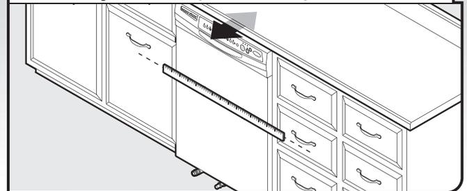
Aligner l'avant du panneau de porte du lave-vaisselle avec les portes des placards. Il faudra peut-être ajuster l'alignement de celui-ci pour qu'il soit en affleurement avec les placards.
