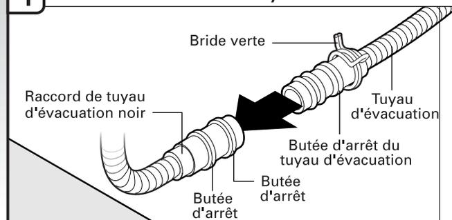
Placer une serviette sous le tuyau d'évacuation pour récupérer l'eau restée dans le tuyau d'évacuation. Placer la petite bride verte pour tuyau d'évacuation sur la petite extrémité du tuyau d'évacuation. Enfoncer le tuyau d'évacuation neuf dans le connecteur noir de tuyau d'évacuation jusqu'à la butée d'arrêt du tuyau d'évacuation.
