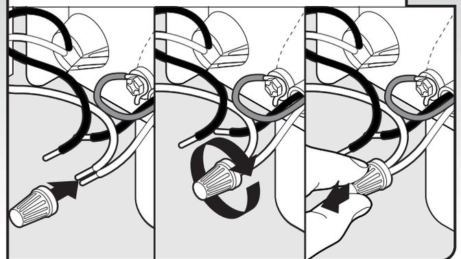
**REMARQUE :** Ne pas pré-torsader les brins des conducteurs. Installer un serre-câble (homologation UL ou CSA). Tirer doucement sur les conducteurs pour vérifier qu'ils sont bien fixés.
