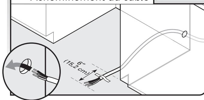
Acheminer le câble de la source d'alimentation électrique à travers le trou dans le placard (le câble doit dépasser par le côté avant droit de l'ouverture d'encastrement du placard).
