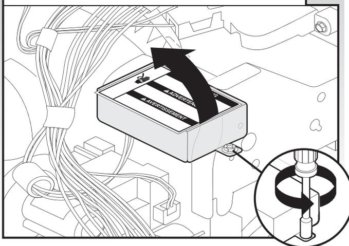
Utiliser une clé à douille hexagonale, un tourne-écrou de 1/4" ou un tournevis Phillips; démonter le couvercle du boîtier de connexion; conserver les pièces pour réutilisation éventuelle.
