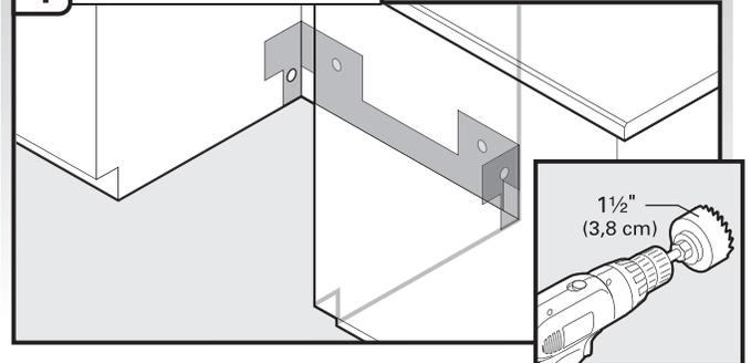
Si nécessaire, percer un trou de  $1\frac{1}{2}$ " (3,8 cm) de diamètre dans la paroi du placard ou l'arrière de l'ouverture la plus proche de l'évier.
