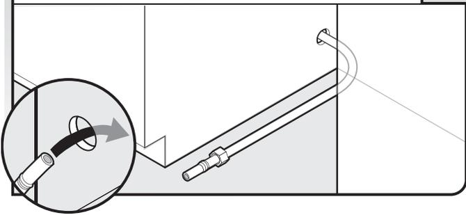
Acheminer lentement la canalisation d'alimentation en eau à travers le trou du placard. (On doit travailler prudemment si l'on utilise une canalisation de cuivre : celle-ci est malléable et se déforme ou s'écrase facilement.) La canalisation de cuivre doit s'avancer suffisamment loin dans l'ouverture d'encastrement du placard pour pouvoir être raccordée au point d'entrée du lave-vaisselle situé sur le côté avant gauche de celui-ci.
