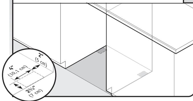
Planchers surélevés (la hauteur du plancher de la cuisine est supérieure à celle de l'ouverture d'encastrement du placard). Par exemple : Le carrelage du plancher de la cuisine n'arrive pas jusque dans l'ouverture du placard. Ajouter des cales selon le besoin dans la zone indiquée pour placer le lave-vaisselle à une hauteur maximale de 34" (86,4 cm) sous le plan de travail.
