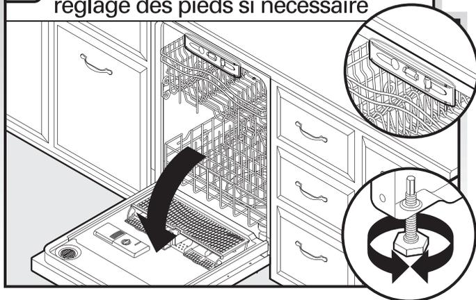
Placer le niveau contre la partie supérieure de l'ouverture avant de la cuve. Vérifier l'aplomb transversal de l'appareil. Si le lave-vaisselle n'est pas d'aplomb, régler la hauteur des pieds avant vers le haut ou vers le bas jusqu'à ce que le lave-vaisselle soit d'aplomb.
