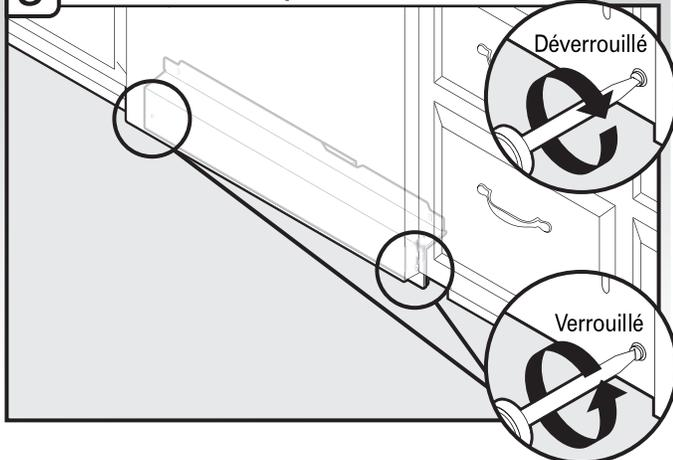
À l'aide d'un tournevis à lame plate, tourner les dispositifs de fixation d'un quart de tour pour les verrouiller. L'encoche du dispositif de verrouillage sera complètement à la verticale lorsqu'elle est correctement verrouillée.
