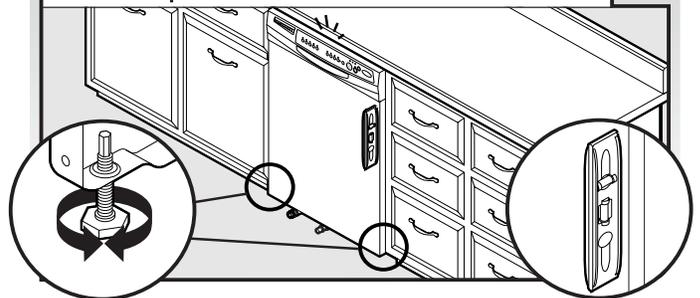
Vérifier que chaque pied de réglage de l'aplomb est fermement en appui sur le sol. Fermer et verrouiller la porte; placer un niveau contre le panneau avant. Vérifier que le lave-vaisselle est centré de l'avant vers l'arrière dans l'ouverture. Si nécessaire, régler le pied de nivellement jusqu'à ce que le lave-vaisselle soit d'aplomb. Répéter ces opérations pour l'autre côté du lave-vaisselle.
