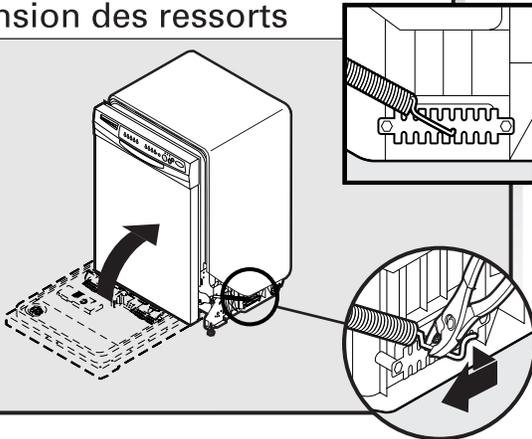
Si la porte se ferme trop rapidement, réduire la tension des ressorts : déplacer le point d'ancrage de l'extrémité du ressort vers l'avant du lave-vaisselle.
