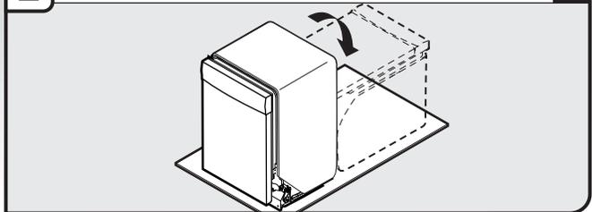
**Conseil utile :** Pour éviter d'endommager le sol, laisser une feuille de carton sous le lave-vaisselle jusqu'à son installation dans la cavité d'encastrement. Ne pas utiliser le panneau de porte comme surface de travail sans d'abord l'avoir recouvert d'une serviette pour éviter de l'endommager.
