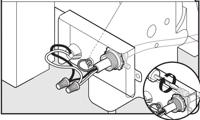
Resserrer les vis de serre-câble pour fixer le câble.
