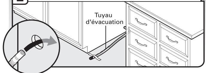
Insérer le tuyau d'évacuation tel qu'indiqué à travers le trou dans le placard et l'acheminer jusqu'au point de raccordement du tuyau d'évacuation (au centre de l'ouverture, à l'avant). Fixer le tuyau d'évacuation au plancher avec du ruban adhésif dans la zone indiquée. Cela l'empêchera de bouger lors de l'insertion du lave-vaisselle dans l'ouverture du placard.
