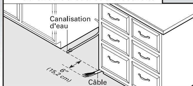
Si la canalisation d'eau et le câble dépassent des emplacements indiqués, passer à la section "Installation du tuyau d'évacuation". S'ils ne sont pas assez longs, suivre les instructions dans la section "Préparation de l'ouverture d'encastrement du placard - Nouveaux moyens de raccordement".
