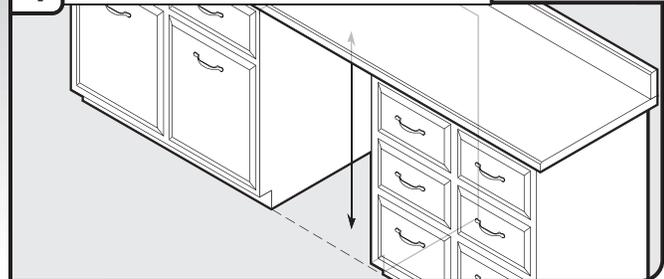
Mesurer la hauteur de l'ouverture d'encastrement du placard entre le dessous du plan de travail et le plancher, à l'emplacement d'installation du lave-vaisselle (la mesure doit être prise entre le point le plus bas depuis le dessous du plan de travail et le point le plus haut du plancher). Consulter le "Tableau de réglage de la hauteur du lave-vaisselle" pour la position des roulettes et le nombre de tours nécessaires.
