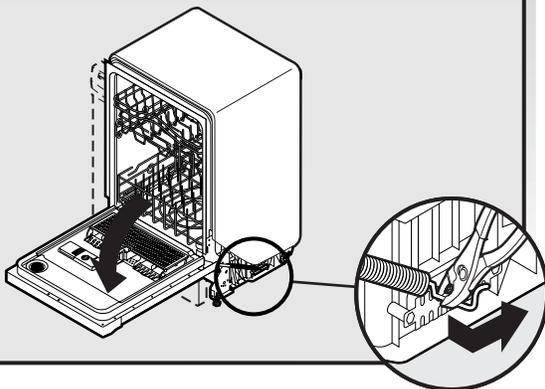
Lorsque la porte s'ouvre d'elle-même, augmenter la tension du tendeur en déplaçant l'extrémité du ressort vers l'arrière du lave-vaisselle.
