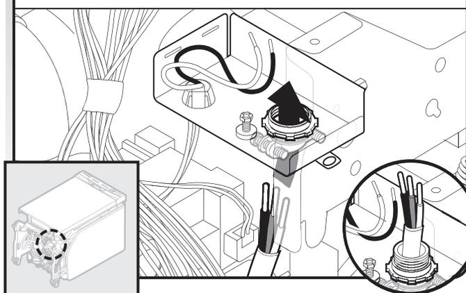
Acheminer le cordon d'alimentation de façon à ce qu'il ne touche pas la zone située entre le moteur du lave-vaisselle et la partie inférieure de la cuve du lave-vaisselle. Tirer le cordon pour l'acheminer à travers le serre-câble dans le boîtier de connexion.
