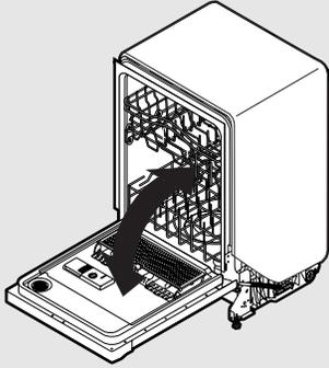
Alors qu'une autre personne retient l'appareil pour l'empêcher de basculer, ouvrir et refermer la porte plusieurs fois. Si la porte se ferme ou s'ouvre sous l'effet de son propre poids, il sera nécessaire d'ajuster la tension du ressort de la porte.
