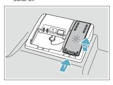
2. Ajoutez le produit de rinçage liquide au distributeur 28 à pleine capacité. Ne le remplissez pas outre mesure. Évitez tout déversement dans le trou d'aération.
