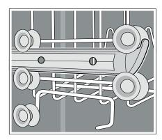
élever, poussez les peignes rabattables dans une position verticale jusqu'à ce que le support s'encliquette dans l'encoche.
