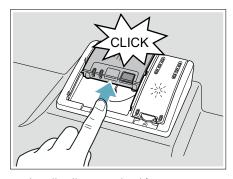
Le distributeur de détergent s'ouvrira automatiquement au moment approprié pour le cycle défini. Le détergent liquide ou en poudre est dispersé dans l'appareil et dissout, les comprimés détergents tombent dans le compartiment à détergent 22 où ils se dissolvent tout au long du cycle.
