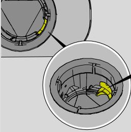
Assurez-vous que l'arrêt de pompe de vidange jaune (à droite dans le drain inférieur) est en place.
