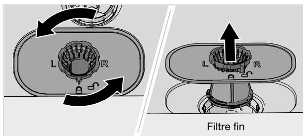
1. Tournez l'anneau de verrouillage dans le sens des aiguilles d'une montre et soulevez le filtre à microparticules vers le haut.
