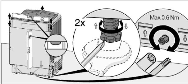
4. Ajustez les pattes avant en les tournant dans le sens des aiguilles d'une montre pour relever la machine, ou l'inverse pour l'abaisser.
