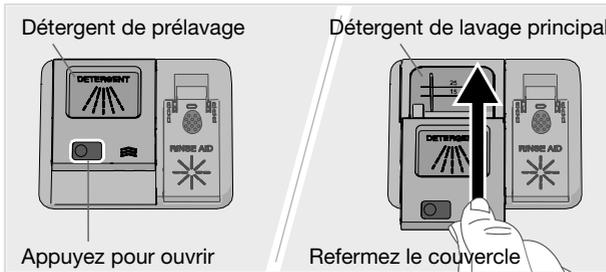
Le compartiment pour détergent doit être sec au moment d'ajouter du détergent. Le lave-vaisselle dispose d'un compartiment pour le pré-lavage et d'un autre pour le lavage principal. Si vous utilisez un détergent en poudre ou en gel pour lave-vaisselle, vous pouvez en ajouter une petite quantité dans le compartiment de pré-lavage. En cas de questions concernant le détergent, contactez le fabricant.
