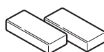
Piezas de madera de desecho o bloques de relleno, si fuera necesario, para el espaciado del gabinete superior (solo para uso en instalaciones de gabinetes superiores empotrados)
