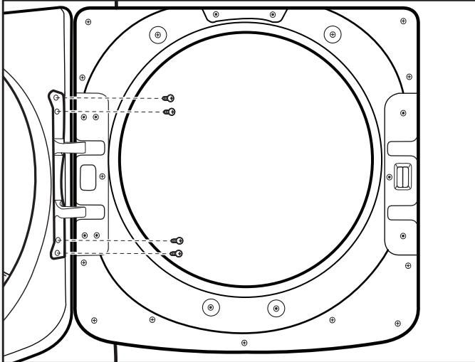
Con un destornillador T25<sup>®</sup> quite los cuatro tornillos que aseguran la bisagra de la puerta a la secadora, levante y saque la puerta. Coloque la puerta sobre una toalla suave u otra superficie que no raye. Conserve los cuatro tornillos o déjelos a un lado.
