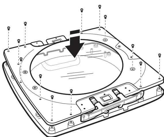
Coloque la puerta interior sobre el ensamblaje de la puerta exterior. Usando un destornillador Phillips, asegúrelo con los 13 tornillos que se quitaron anteriormente.
