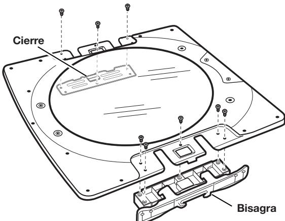
Con un destornillador T25®, vuelva a instalar la placa del pestillo y el ensamblaje de la bisagra en los lados opuestos de los que se retiraron.
