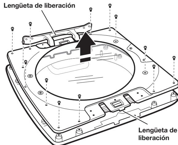
Coloque la puerta con el lado interior mirando hacia arriba. Con un destornillador Phillips, quite los 13 tornillos que aseguran la puerta interior a la exterior. Levante y quite la puerta interior y colóquela a un lado.
