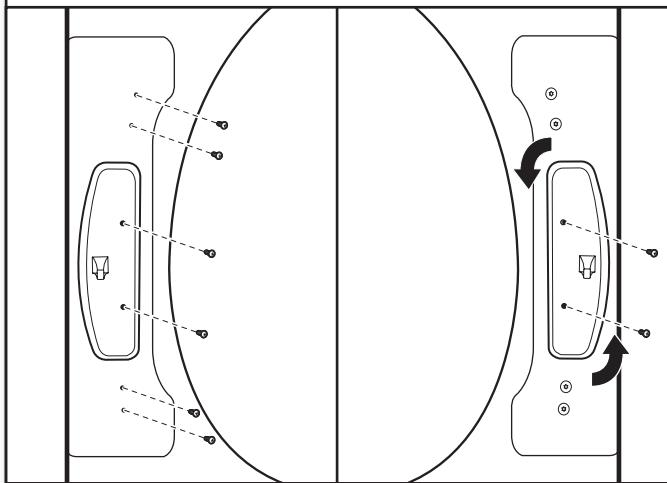
Con un destornillador T25<sup>®</sup>, quite los dos tornillos que aseguran el tope de la puerta al marco de la puerta de la secadora. Quite los cuatro tornillos que están por encima y por debajo del tope de la puerta y déjelos a un lado para usarlos posteriormente. Gire el tope 180° y asegúrelo al lado opuesto del marco de la puerta de la secadora, como se muestra.
