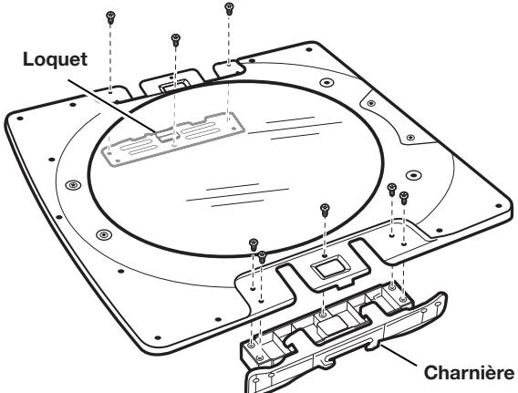
À l'aide d'un tournevis T25®, réinstaller la plaque de protection du loquet, la plaque de support du loquet et la charnière sur les côtés dont elles ont été respectivement retirées.
