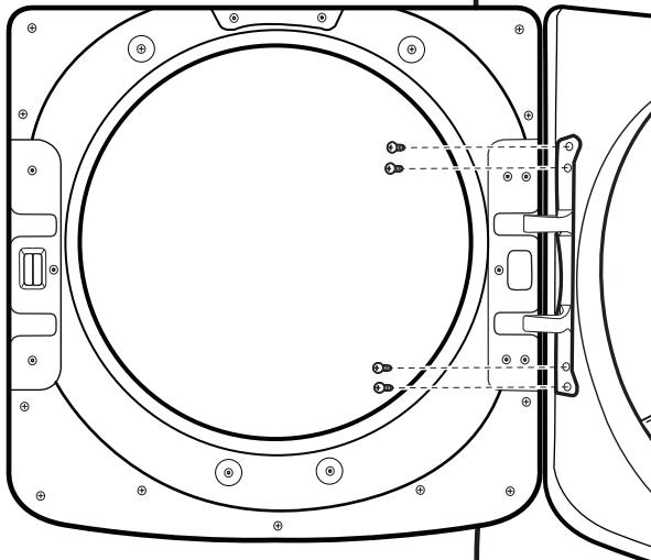
Con un destornillador T25®, vuelva a colocar los cuatro tornillos que aseguran la bisagra de la puerta a la secadora.
