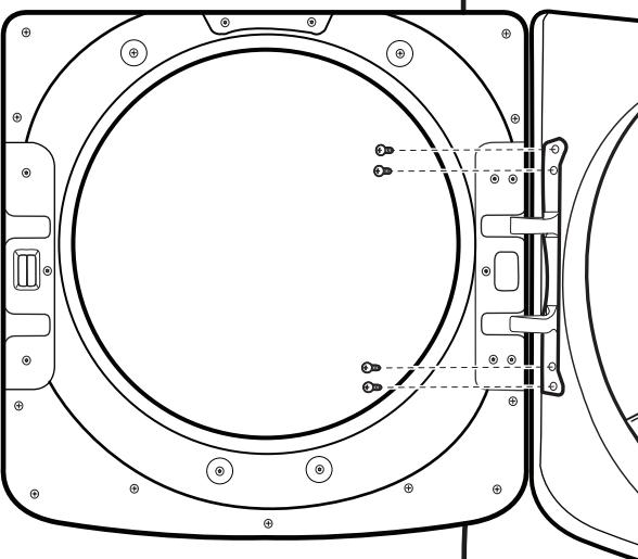
À l'aide d'un tournevis T25®, réinstaller les quatre vis fixant la charnière de la porte à la sécheuse.
