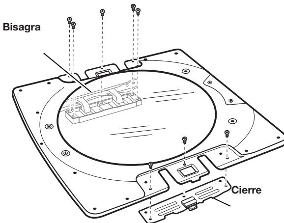
Con un destornillador T25<sup>®</sup> quite los tres tornillos que aseguran la placa del pestillo y los cinco tornillos que sujetan el ensamblaje de la bisagra en su lugar.
