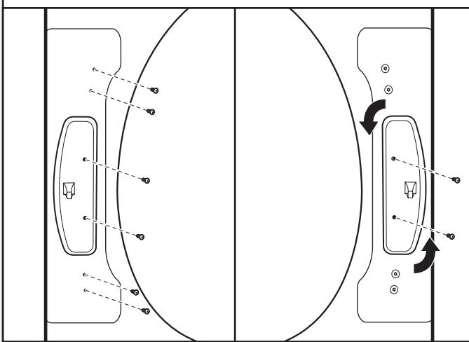
À l'aide d'un tournevis T25®, retirer les deux vis fixant la gâche de la porte au châssis de la porte de la sécheuse. Retirer les quatre vis au-dessus et en dessous de la gâche de la porte et les mettre de côté pour utilisation ultérieure. Faire pivoter la gâche de 180° et la fixer au côté opposé du châssis de la porte de la sécheuse, tel qu'indiqué.
