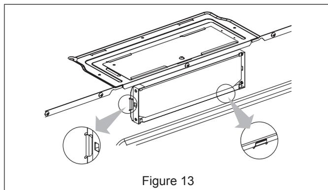
Assurez-vous que la charnière du clapet est en haut et que le clapet bascule librement dans la sortie murale.
