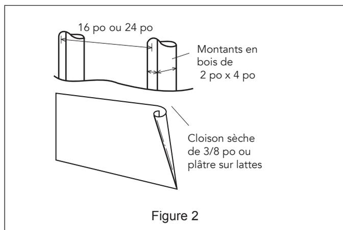
**REMARQUE :** S'il est impossible de fixer l'appareil à un montant du mur, il faudra porter une attention particulière au placement des ancrages à boulon et des vis pour l'armoire supérieure. Consultez le Gabarit mural pour les détails. L'armoire supérieure devrait être testée pour vérifier qu'elle est solidement fixée au mur. Placez jusqu'à 110 livres (50 kg) de poids supplémentaire dans l'armoire supérieure pour tester sa capacité de soutien.
