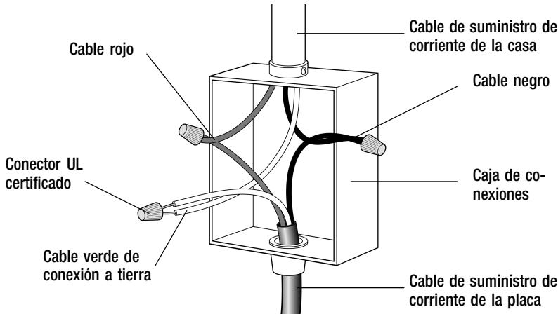
Si la placa se instala y conecta como se especificó anteriormente, estará totalmente conectada a tierra conforme al Código Nacional Eléctrico.
