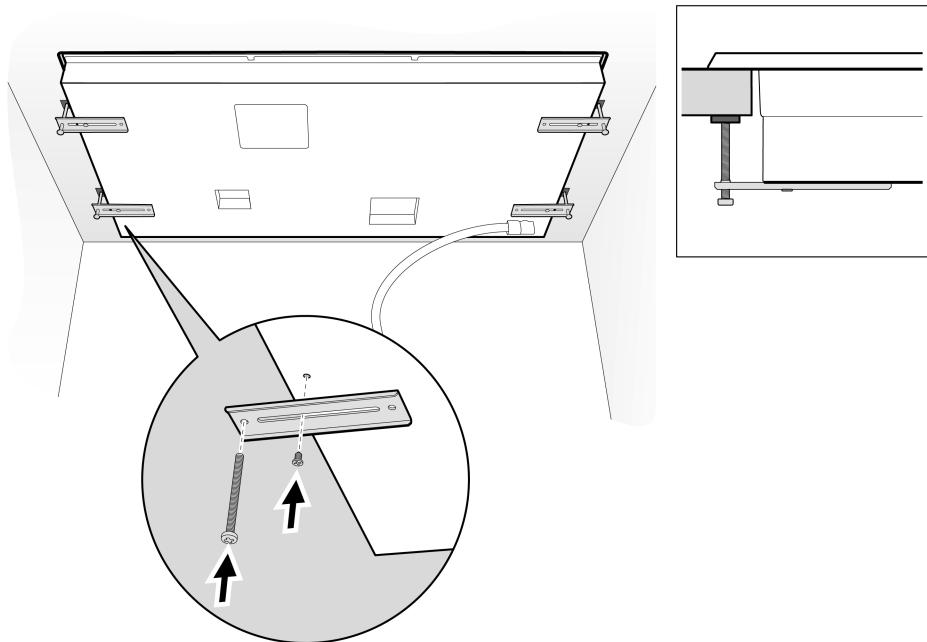
La plaque doit être fixée au plan de travail avec les supports de fixation fournis.
