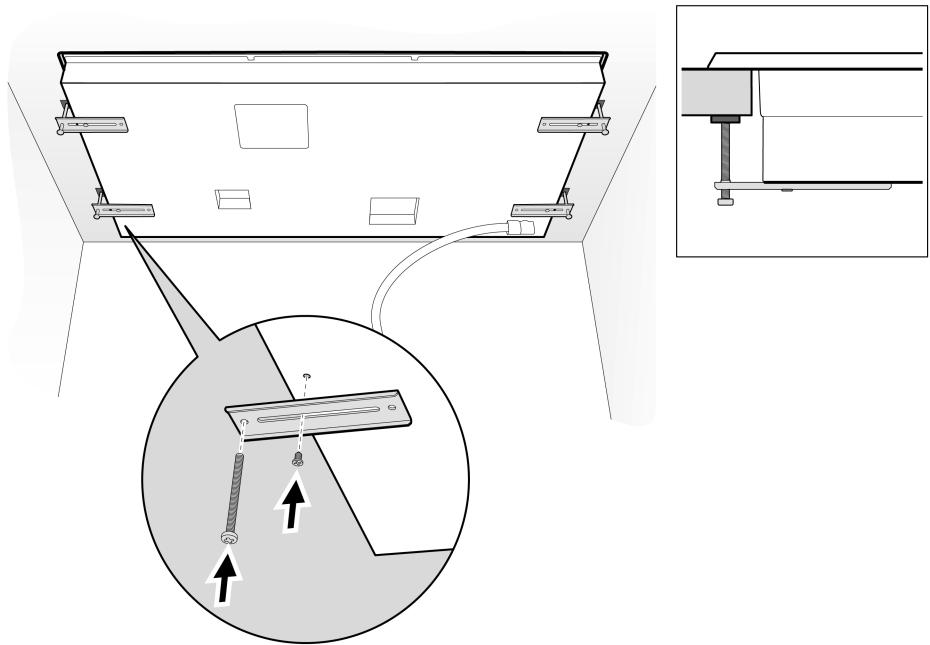
La placa debe asegurarse a la superficie de trabajo con los soportes de sujeción provistos.
