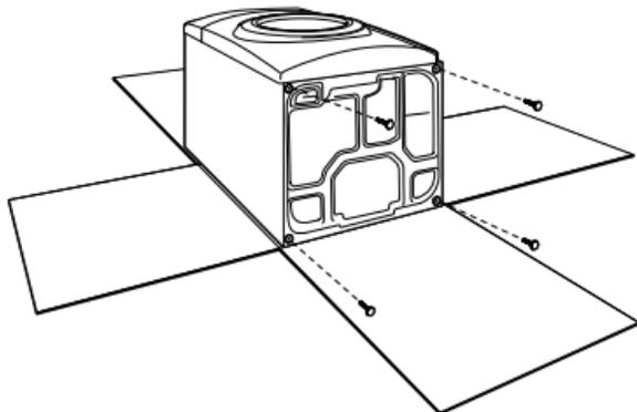
Afin d'éviter d'endommager le plancher, utiliser un grand morceau de carton plat extrait de la boîte d'emballage de la sècheuse et le placer sous toute la partie arrière de la sècheuse. Saisir fermement le corps de la sècheuse (et non pas le panneau de la console), puis poser la sècheuse sur le carton avec précaution.
