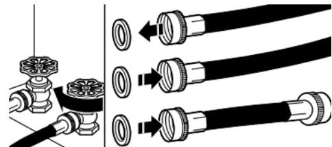
Fermer le robinet d'eau froide et ôter le tuyau d'alimentation de la laveuse. Retirer l'ancienne rondelle en caoutchouc du tuyau d'arrivée d'eau et la remplacer par la nouvelle rondelle en caoutchouc.
