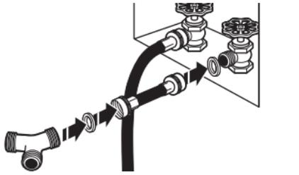
Fixer le tuyau d'alimentation de 2 pi (0,6 m) au robinet d'eau froide. Visser le raccord à la main pour qu'il repose sur le robinet. Fixer le raccord en « Y » à l'extrémité mâle du tuyau d'alimentation de 2 pi (0,6 m). Visser le raccord à la main jusqu'à ce qu'il repose sur le raccord.
