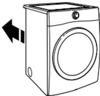
Placer la sécheuse à son emplacement final. Éviter d'écraser ou de déformer le conduit d'évacuation.
