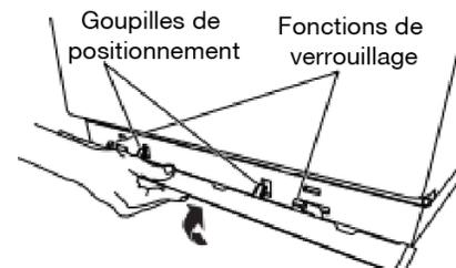
**Installation :** Placer la jupe au bas de la sécheuse et faire correspondre les goupilles de positionnement avec les trous. Appuyer sur la jupe fermement vers le haut jusqu'à ce qu'elle s'enclenche.
