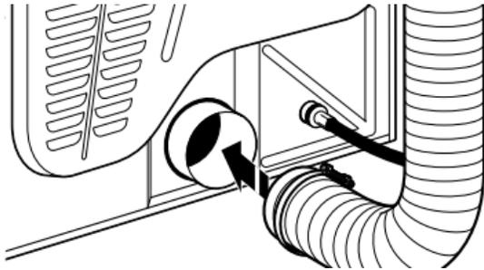
À l'aide d'une bride de fixation de 4 po (102 mm), relier le conduit d'évacuation à la bouche d'évacuation de la sécheuse. Si l'on réalise le raccordement au conduit d'évacuation existant, s'assurer que celui-ci est propre. Le conduit d'évacuation doit être fixé par-dessus la bouche d'évacuation de la sécheuse et à l'intérieur du conduit d'évacuation. S'assurer que le conduit d'évacuation est fixé au clapet d'évacuation à l'aide d'une bride de fixation de 4 po (102 mm).
