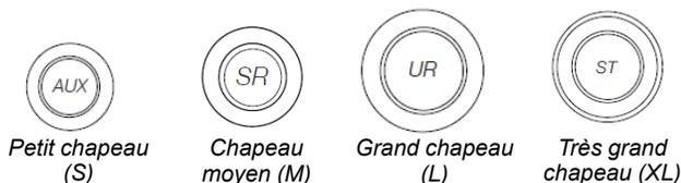
6. Allumer le brûleur. Si le brûleur ne s'allume pas, vérifier l'alignement du chapeau. Si le brûleur ne s'allume toujours pas, éteindre le brûleur. Ne pas réparer le brûleur soi-même. Contacter un technicien de réparation qualifié.
