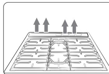
Les orifices de ventilation du four et de refroidissement se trouvent à l'arrière du four de la cuisinière. Une bonne circulation de l'air permet d'éviter les problèmes de combustion et d'assurer de bonnes performances.
