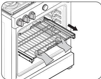
Lorsque la grille coulissante est en position « fermée » et que le four est éteint et froid, saisissez la grille et le cadre et tirez-les vers l'avant pour les retirer.
