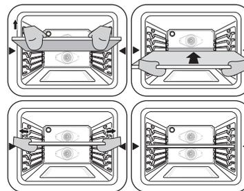
1. Insérez la plaque de séparation dans la 4e position de grille de la cavité.
