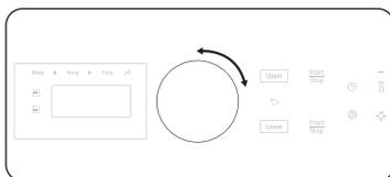
Pour activer le panneau de commande, enfoncez ou tournez le bouton de réglage. Les préférences de l'utilisateur sont disponibles dans ce mode, notamment la minuterie, l'éclairage du four et le verrouillage des commandes.
