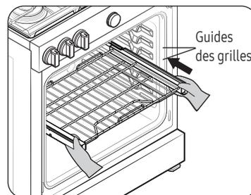
Avec la grille coulissante en position « fermée » et le four éteint, insérez soigneusement la grille coulissante entre les guides jusqu'à ce qu'elle atteigne l'arrière.
