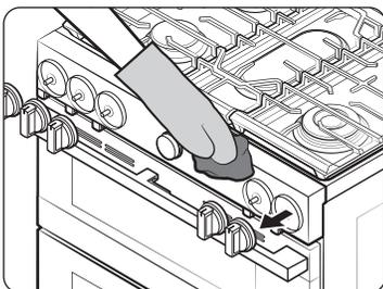
1. Retirez les boutons tiges des vannes de contrôle.
