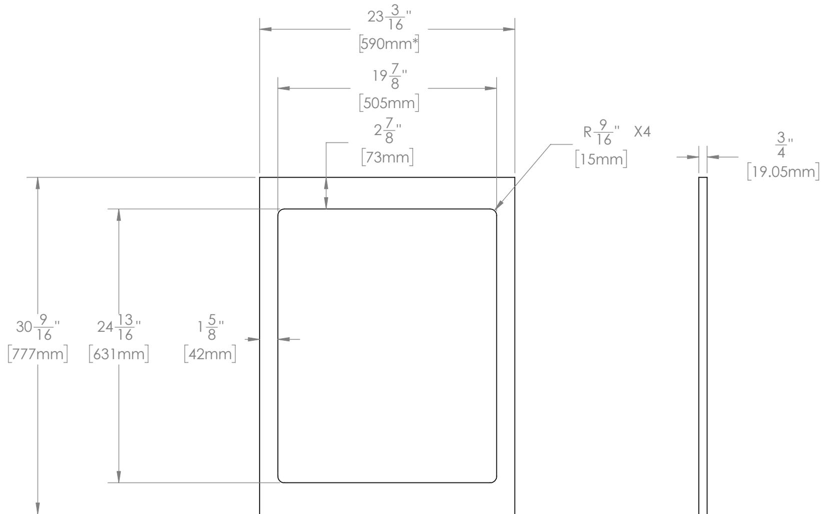
Il est recommandé que le panneau soit de 590 mm de largeur, en ayant une tolérance acceptable de +/- 1 mm. De plus, le cadre en aluminium peut également accueillir des panneaux de 5/8 po d'épaisseur, mais il faudra prévoir l'utilisation de vis plus courtes. Veuillez en tenir compte avec votre installateur.
