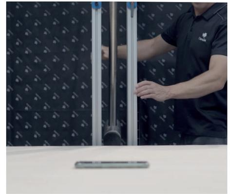
Un impact latéral sert également à tester la solidité de l'assemblage.
