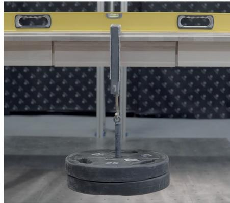
Un poids est placé sur le coin de la table, qui doit rester stable. Ce test simule la pression qu'une personne peut exercer lorsqu'elle s'appuie sur la table pour se lever.
