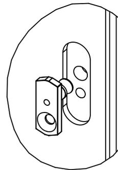
Serrer la vis de réglage dans le couvercle de poignée après le serrage de la vis D
