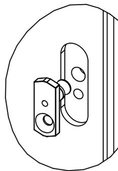
Apriete el tornillo de fijación en la tapa del mango después de apretar el tornillo D
