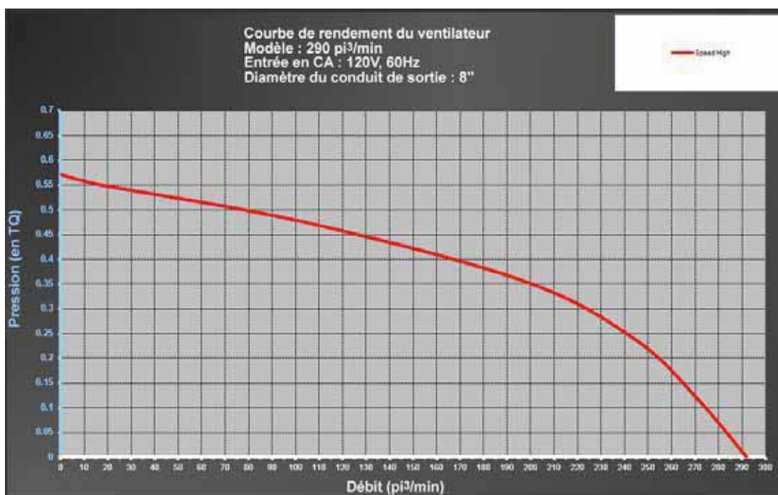
Diagrammes des courbes caractéristiques des ventilateurs
